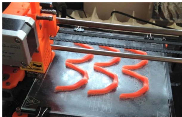
3D print vousů před vytvarováním a nabarvením
