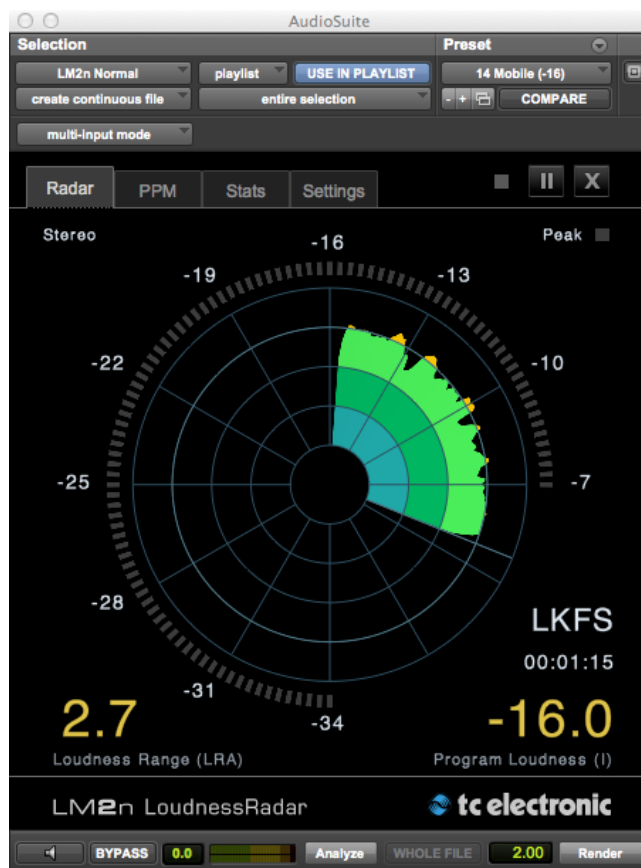
Obrázek 15 Zesílení na -16 LUFS – Výsledky měření – Radar Zdroj: Vlastní
