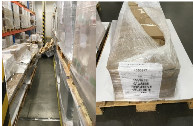
Obrázek 29 Následek nestabilního stohování palet
