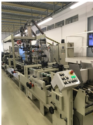
Obrázek 19 Lepicí stroj Heidelberg
