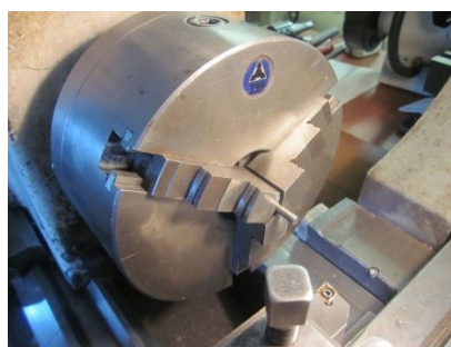
Obr. 15 Znázornění upnutí obrobku do univerzálního tří čelistového sklíčidla.
