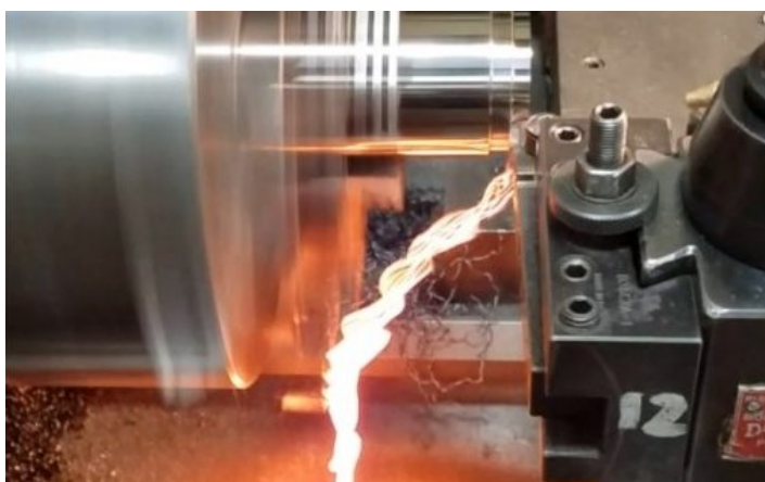
Obr. 1 Obrábění tvrzené oceli na CNC soustruhu pomocí keramické destičky. [1]
