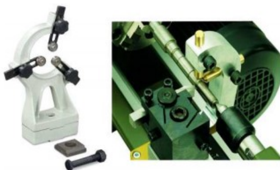
Obr. 18 Na levé straně obrázku je luneta, na pravé straně je sestava lunety, obrobku a stroje. [13]
