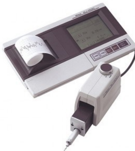
Obr. 10.5 Drsnoměr Mitutoyo SJ-401 [28]
