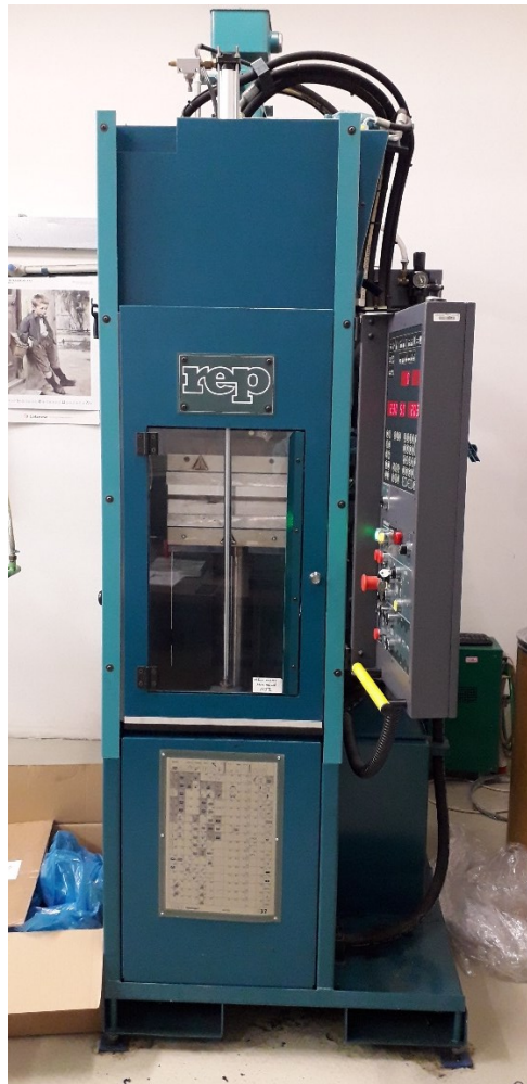
Obr. 11.1 Vstřikovací stroj REP V27 Y125
