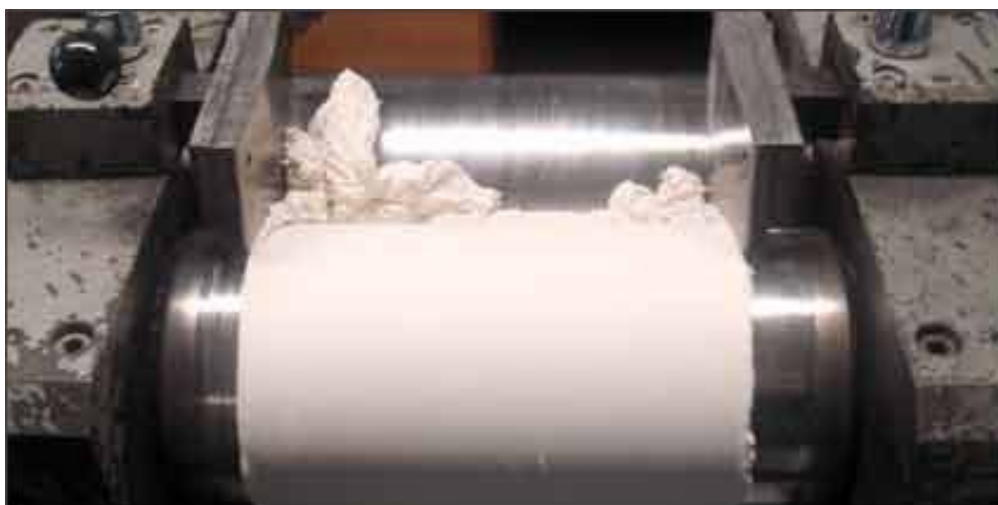
Obr. 3.2 Míchání vzorků směsi na dvouválci [12]
