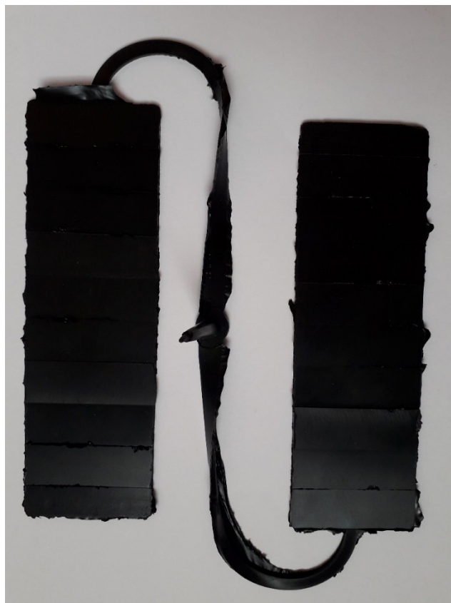
Obr. 11.4 Vzorek z vulkanizovaného kaučuku po vyjmutí z formy
