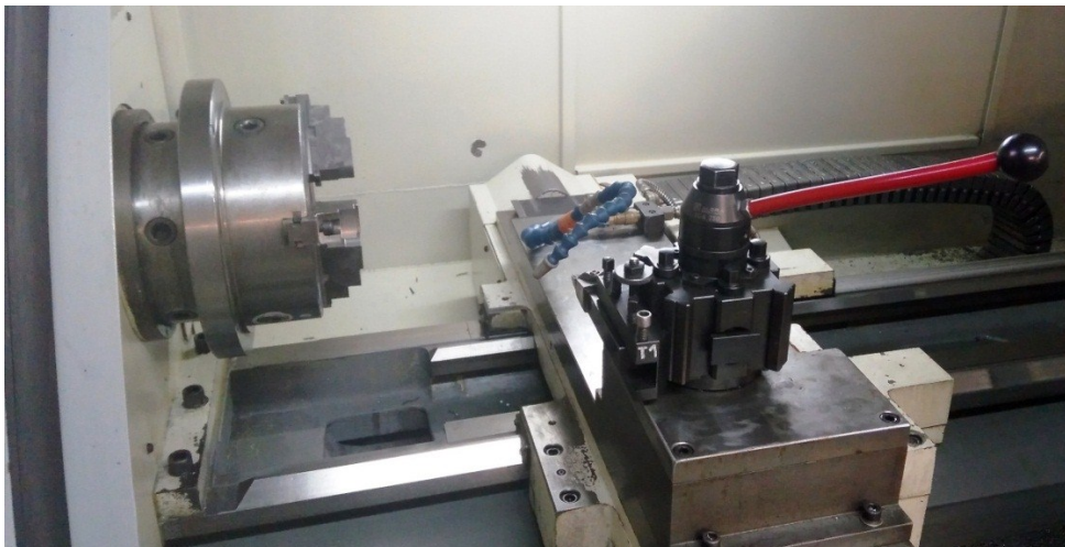
Obr. 22 Detail sklíčidla a otočné nožové hlavy soustruhu
