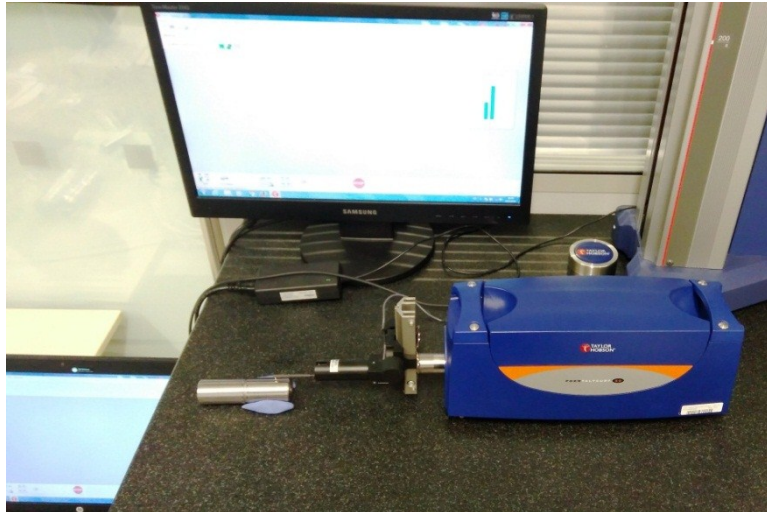
Obr. 25 Měřicí přístroj Taylor Hobson Form Talysurf 50 s monitorem zobrazujícím výsledky měření
