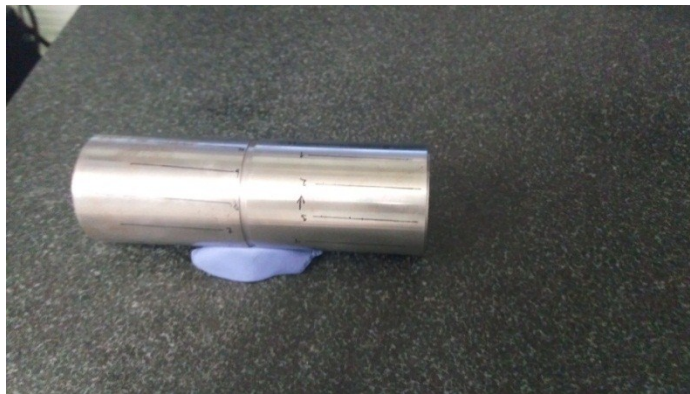
Obr. 43 Upevnění vzorku k měřicímu stolu
