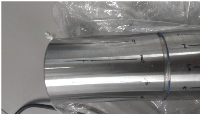
Obr. 42 Připravený vzorek č. III. na měření drsnosti
