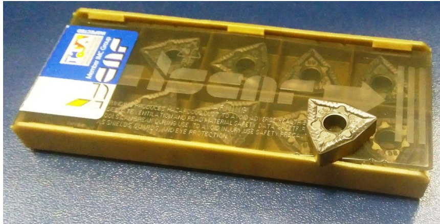
Obr. 33 Vyměnitelné břitové destičky Iscar z SK
