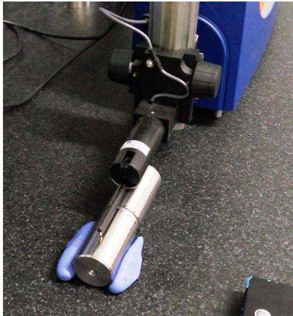
Obr. 24 Měřicí přístroj Taylor Hobson Form Talysurf 50 při měření drsnosti vzorku z oceli ČSN 12050
