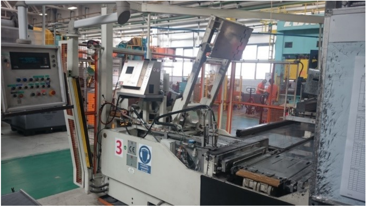
Obr. 7 Skládačka chladičů - stanoviště operátora
