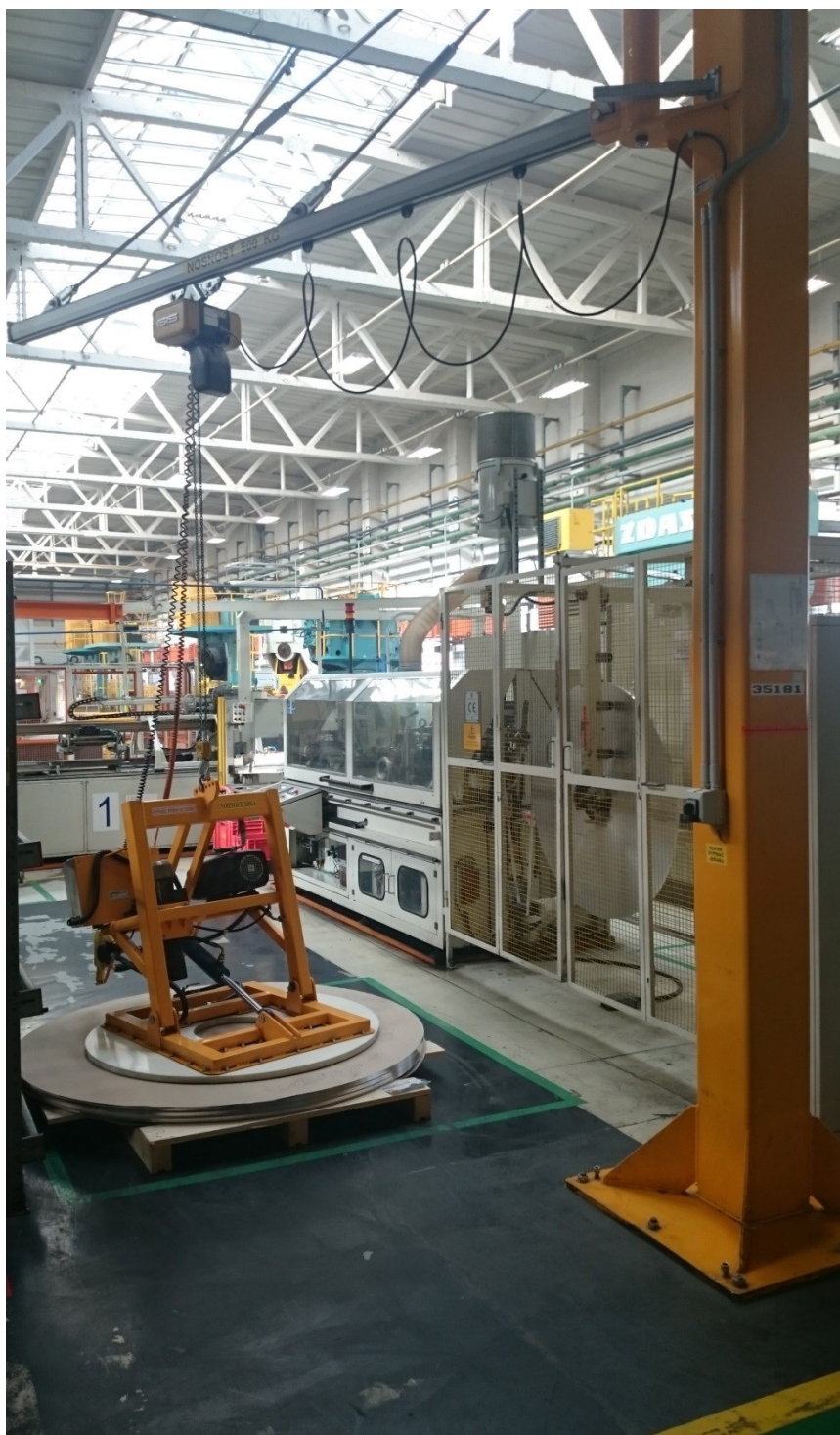
Obr. 5 Sloupový jeřáb s vakuovým manipulátorem
