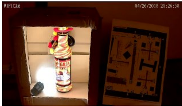
Obr. 32. Test korekce světla v obraze, kamera Jinmanze.
