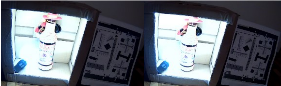
Obr. 24. Korekce světla v obraze kamera Hiseeu 1) bez použití funkcí, 2) BLC.
