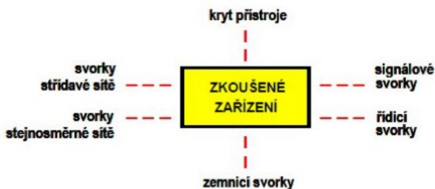
Obr. 13. Základní typy vstupů rušivých signálů do zkoušeného zařízení. [22]
