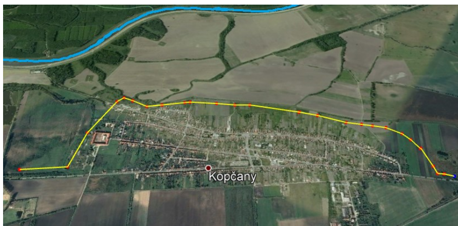
Obr. 26: Rozmiestnenie systému DPS 2000 v blízkosti obce [Zdroj: Autor]
