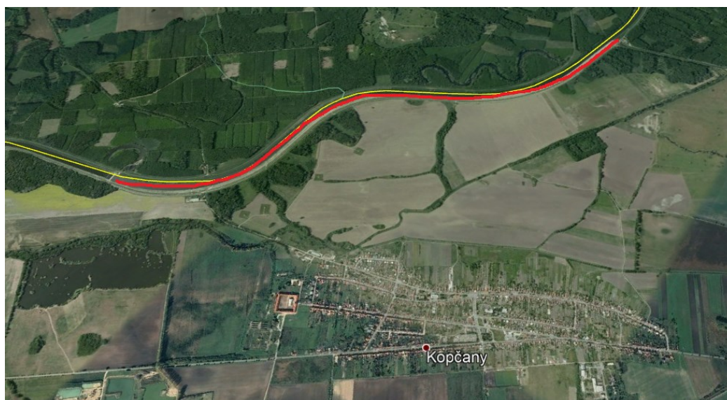
Obr. 27: Rozmiestnenie valcových protipovodňových zábran [Zdroj: Autor]
