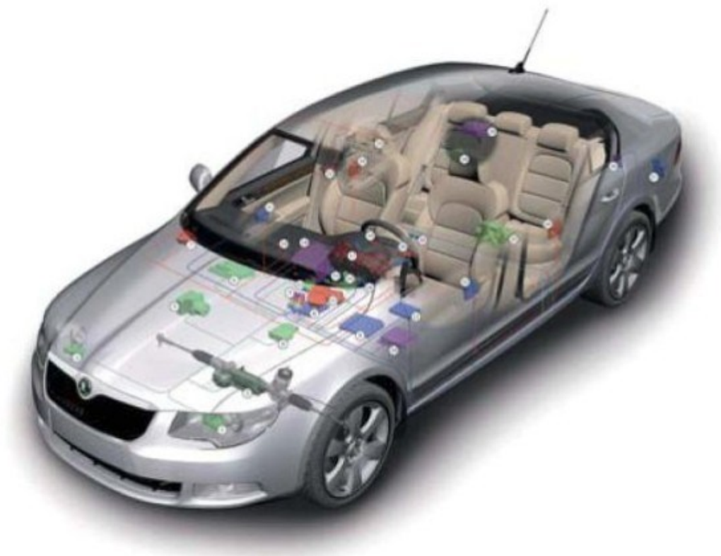
Obr. 8. Umiestnenie elektronických riadiacich jednotiek v Škode Superb [12]
