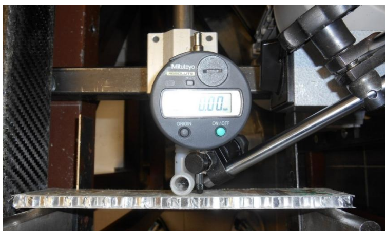
Obr. 6.11 Nastavení průhybu s pomocí číselníkového úchylkoměru
