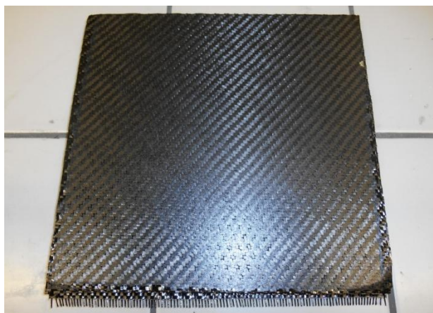
Obr. 6.5 Vylisovaná deska vyjmutá z laboratorního lisu (bAlUv)
