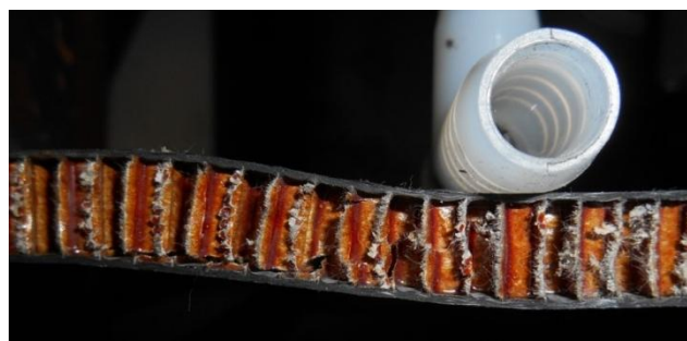
Obr. 7.21 Dlouhá prasklina jádra (smyk jádra), z počátku rovnoběžná s potahem (bNoUv)
