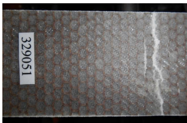
Obr. 7.20 Roztřepená, zdvojená prasklina (bNoSv)
