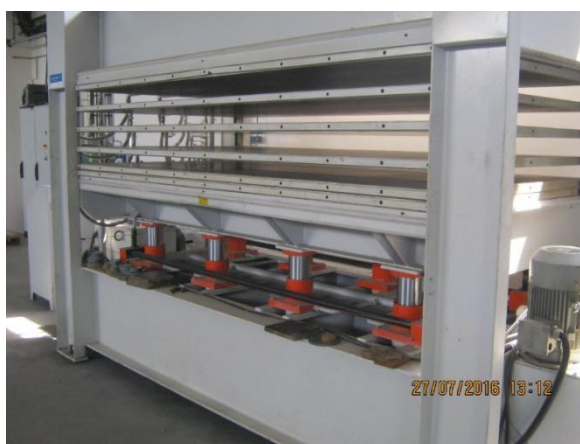
Obr. 6.3 Lis použitý při výrobě sendvičové desky pro výrobu pilotních vzorků
