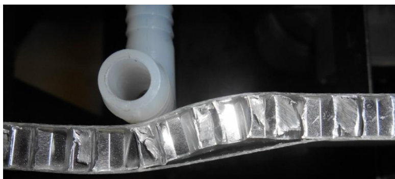
Obr. 7.24 Rozsáhlá deformace jádra a odlepení obou potahů (sAlSv)-(14% vzorků)
