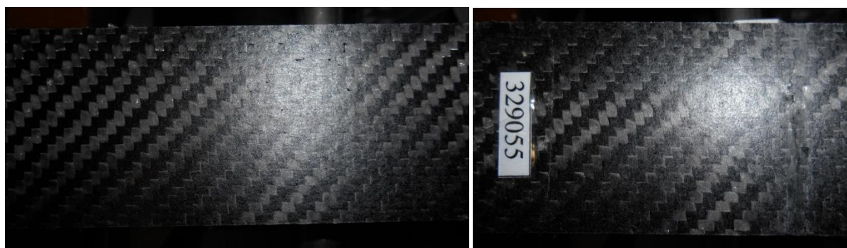
Nepoškozená strana a poškozená strana vzorku č. 329055 (bAlUv)
