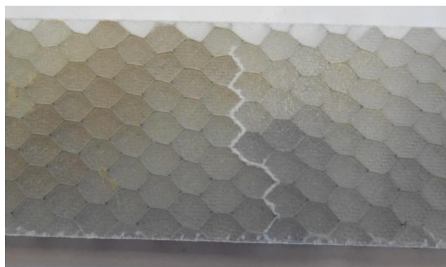
Obr. 7.18 Prasklina potahu po hranicích voštinových buněk (bAlSv)
