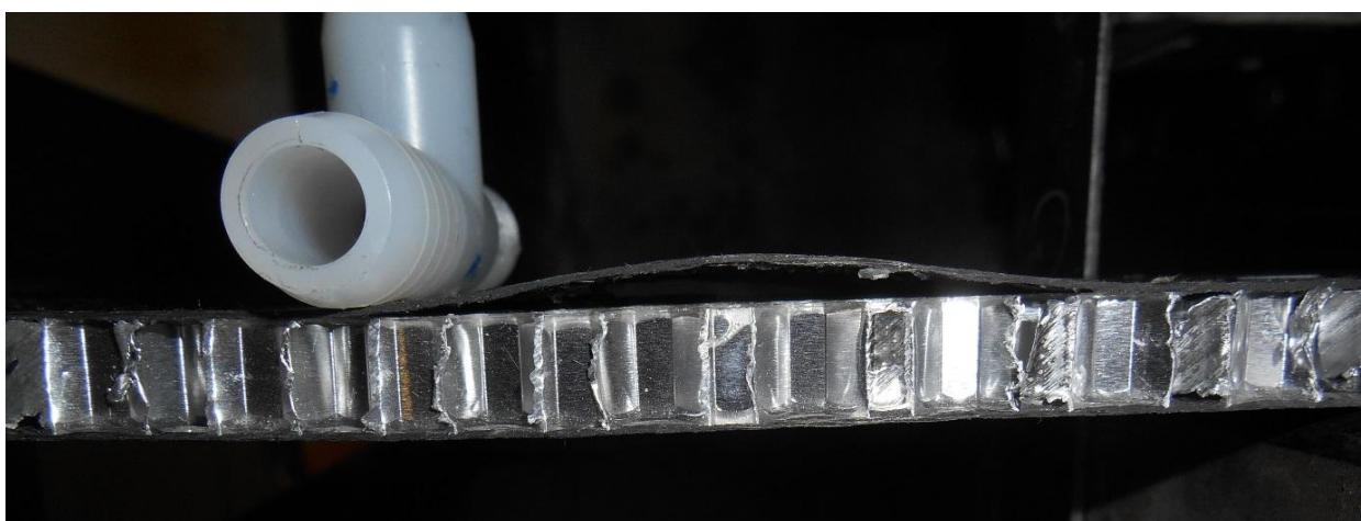
Odlepený potah od jádra (bAlUv) – stejné, jako u pilotních vzorků
