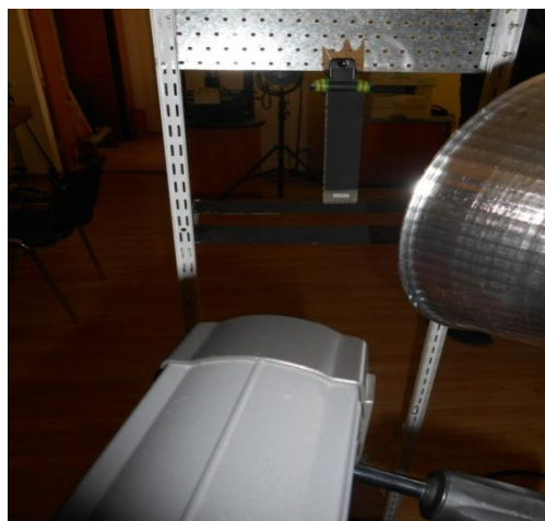
Obr. 6.14 Celkové uspořádání pracoviště pro aktivní IRNDT
