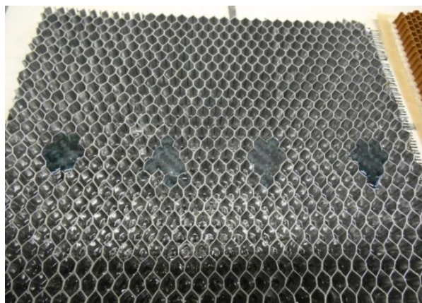
Obr. 6.7 PSP bez jednoho potahu se zalitou zalévací hmotou (sAlUv)
