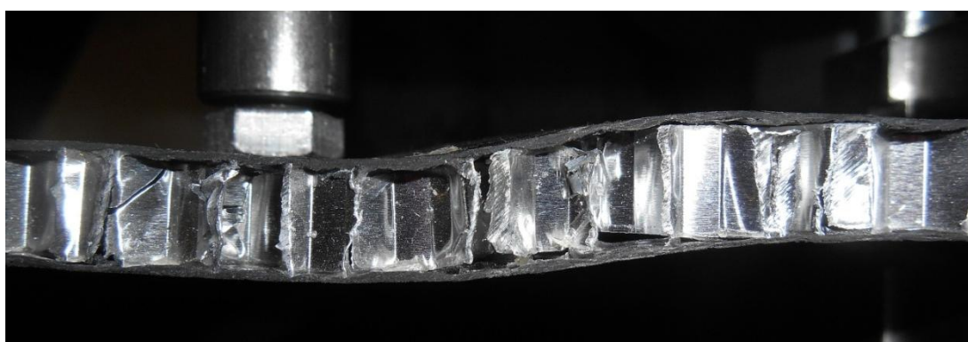
Rozsáhlá deformace jádra a odlepení obou potahů (sAlUv)
