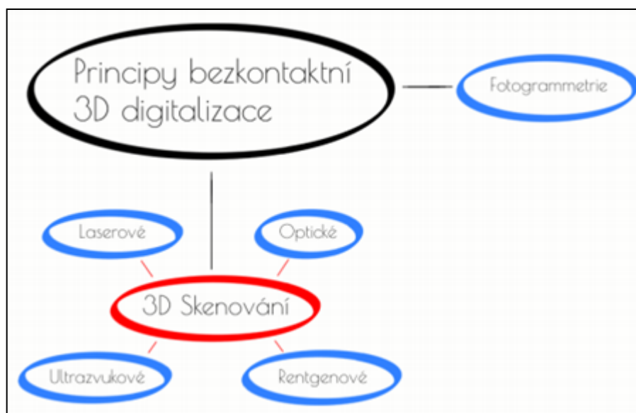
Obr. 9 Principy bezkontaktní 3D digitalizace
