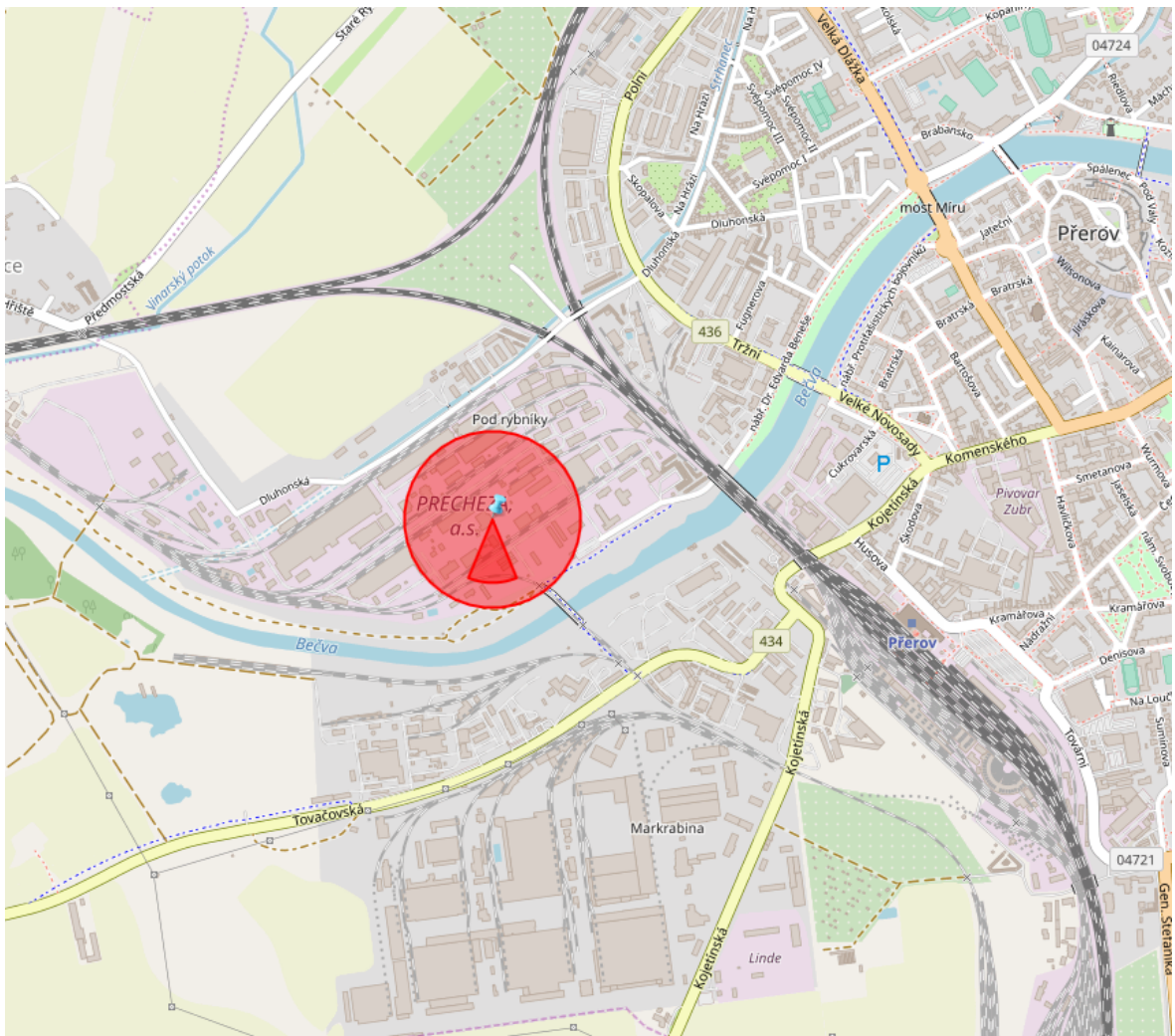
Obrázek 19 – Zóna při úniku acetyleny, výstup z programu TEREX [45]
