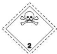
(č. 2.3) Toxické plyny Symbol (lebka na zkřížených kostech): černý; podklad: bílý; číslice "2" v dolním rohu
