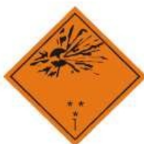
(č. 1) Podtřídy 1.1, 1.2 a 1.3 Symbol (vychující puma): černý; podklad: oranžový; číslice "1" v dolním rohu
