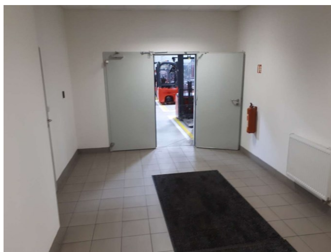
Obrázek 7 – Chybí bezpečnostní značení [23]
