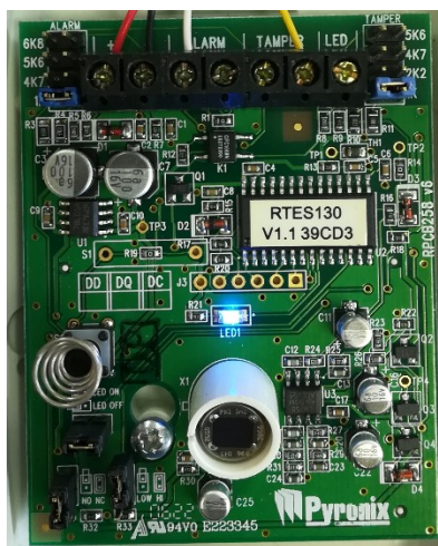
Obr. 11 – Zapojení KX15DQ (dvojitě vyváženo přednastavenými rezistory 1k \Omega )
