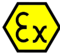
Obrázek 10 Značka pro zařízení určené do prostředí s nebezpečím výbuchu [34]
