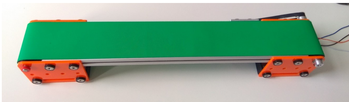
Obrázek 65 Pásový dopravník v laboratoři automatizace
