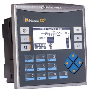
Obrázek 32 PLC Unitronics Vision 130 [25]
