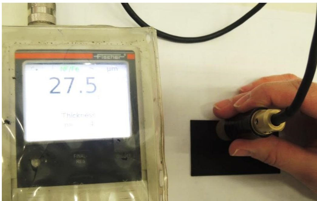
Obr. 4 Měření vrstvy nánosu tloušťkoměrem
