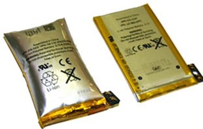
Obr. 23 Príklad batérie deformovanej procesom – gassing [10]
