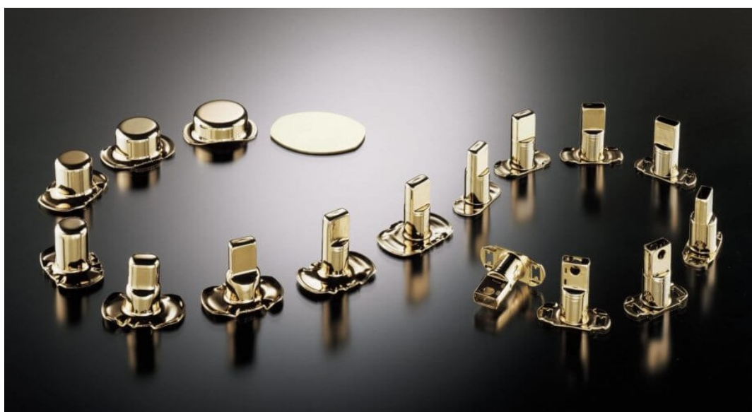
Obr. 13 Vzorový príklad postupového formovania súčiastky [19]
