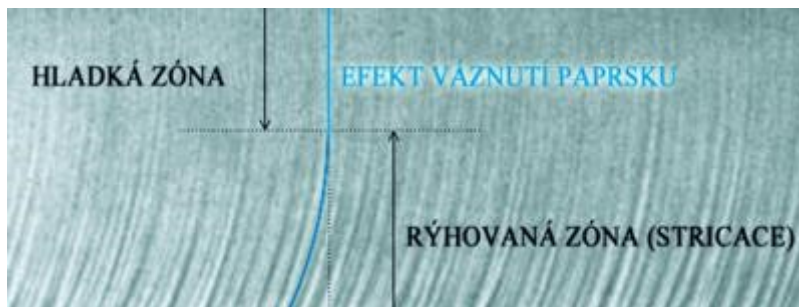
Obrázek 6 – Povrch obrobenej plochy technologií AWJM [11].
