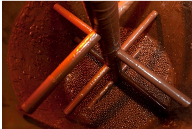
Obrázek č. 16: Konšování pomocí kulového mlýnu [44].
