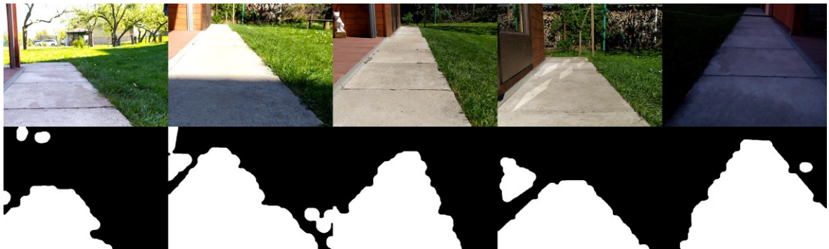
Obrázek 29: Ukázka zpracování obrazu pro zmíněné světelné podmínky, zleva: chodník celý ve stínu, přechod mezi stínem a přímým světlem, přímé světlo, odlesky, šero
