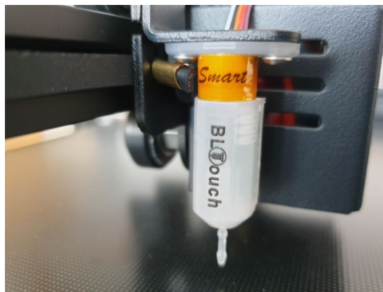
Obrázek 34 Vzhled kalibračního senzoru BLTouch [vlastní]
