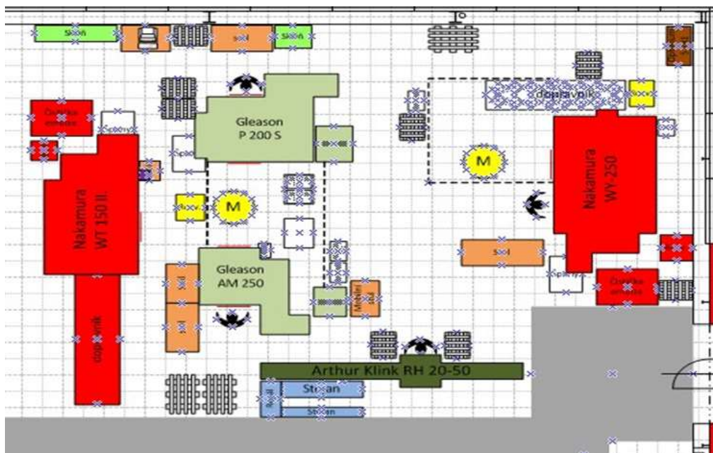
Obrázek 8: Schéma buňkového uspořádání pracoviště (Chromjaková, 2013)
