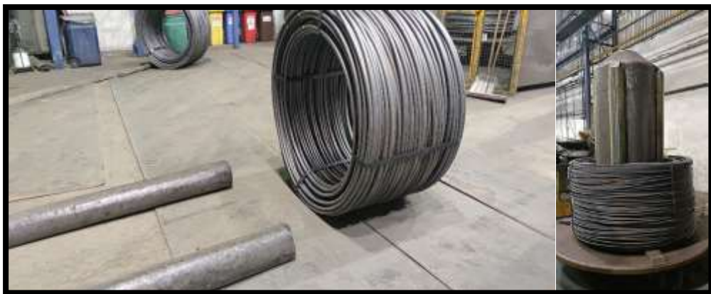
Obrázek 36: Úprava odvíjecího trnu a gumové rohože (vlastní zpracování)
