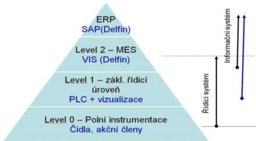
Obrázek 38: Hierarchie výrobního informačního systému (interní materiály firmy)
