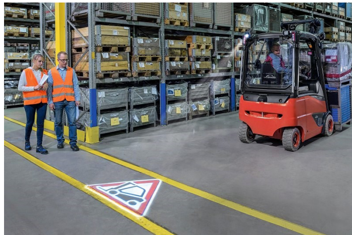
Obrázek 9 Varovný systém TruckSpot (technickytydenik.cz, © 2018)
