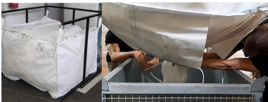
Obrázek 46 Konstrukce BigBag (vlevo) a zkouška vysypání (vpravo) (Vlastní zpracování)
