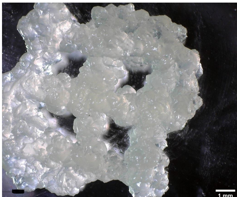
Obr. 15: Výsledný výtisk mřížky na tiskárně Cellink BioX za pomoci špičky 210 kDa 35 %
