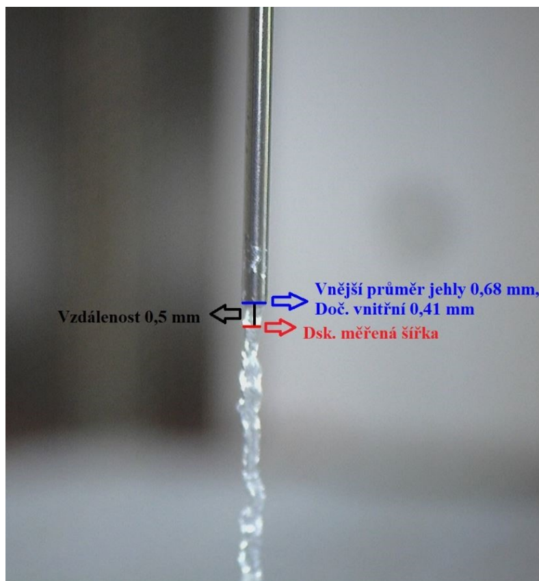
Obr. 16: Názorná ukázka stanovení narůstání za hubicí 210 kDa 25 %
