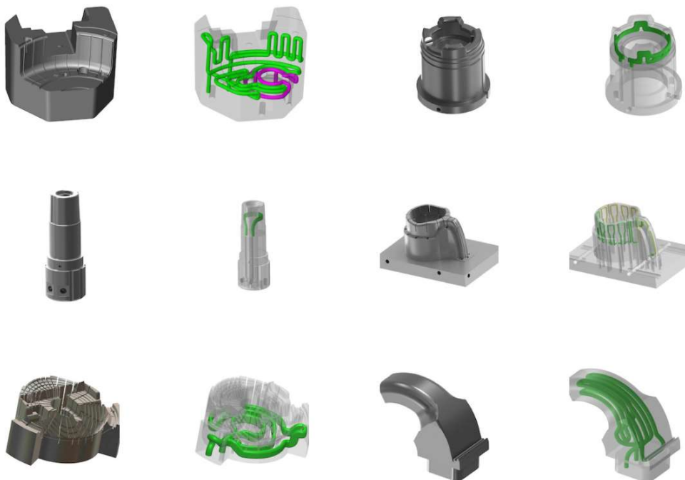
Obr. 21.: Příklady aplikace konformního chlazení [12]
