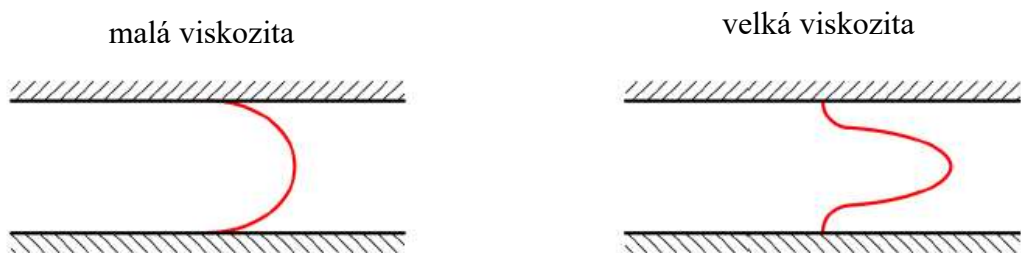
Obr. 5.: Vliv smykové viskozity na tvar čela taveniny [30]
