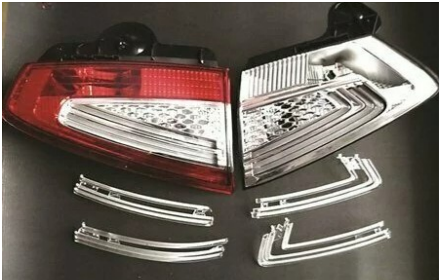
Obr. 6. Světlovod pro koncové světlo Ford [10]
