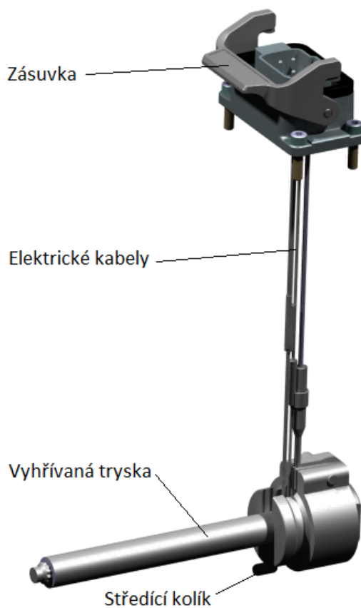
Obr. 29. Vyhřívání tryska včetně kabeláže se zásuvkou
