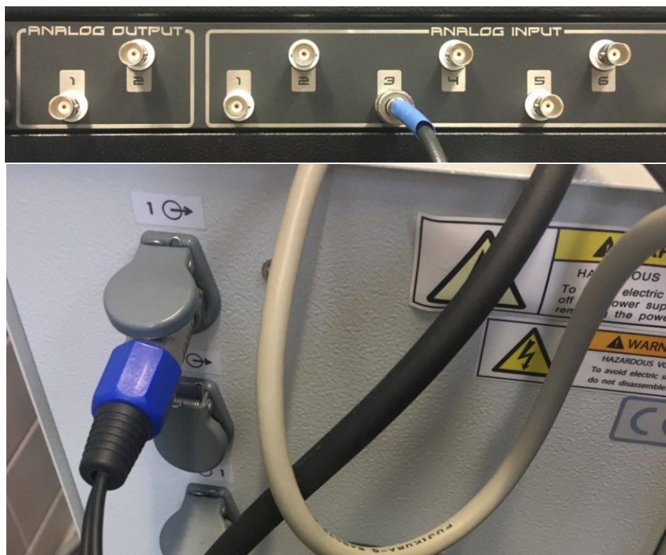
Obrázek 19: Vzájemné propojení zařízení zapojením kabelu do DIC (nahore) a do Shimadzu (dole)
