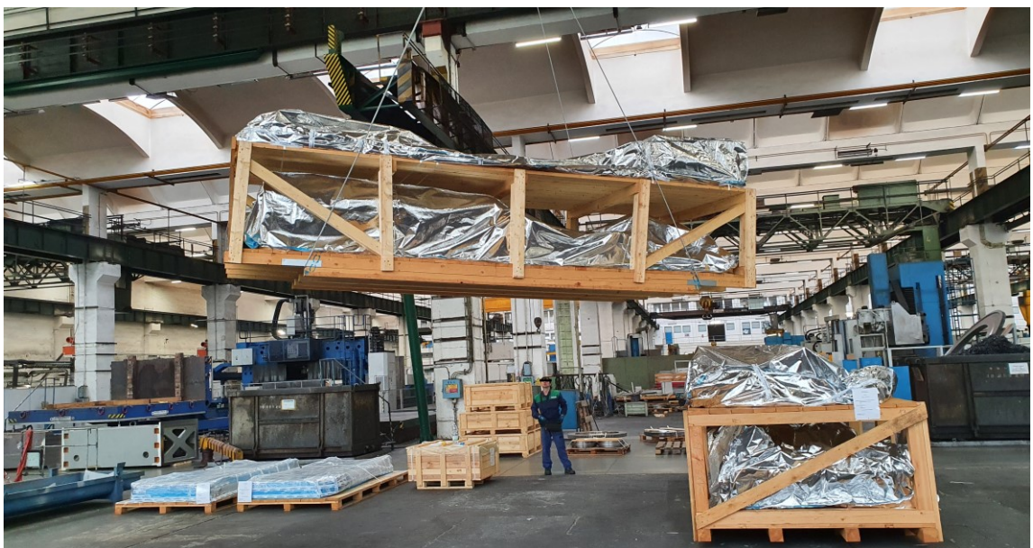
Obrázek 14 Manipulace s patrovými podestami mostovým jeřábem při nakládce [13]
