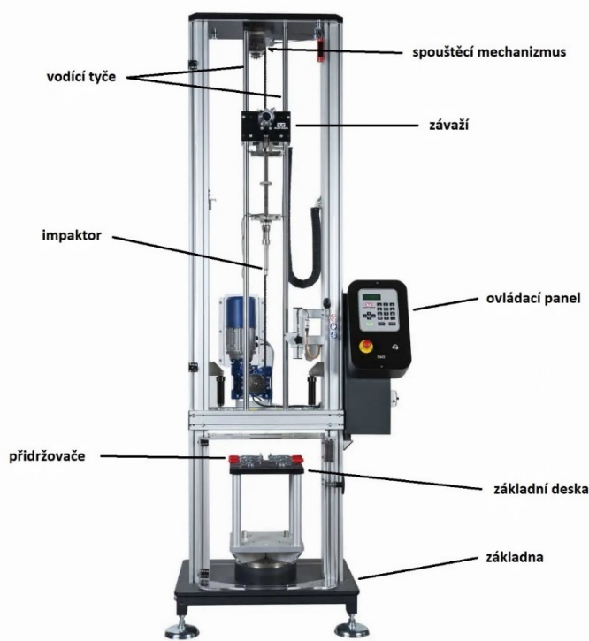
Obr. 16.: Konstrukce pádového stroje [27]
