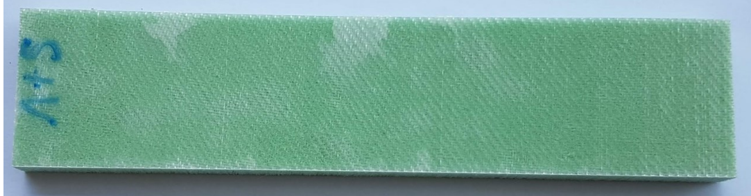
Obr. 47 Delaminace zkušebního tělíka po řezání vodním paprskem (pohledová strana)
