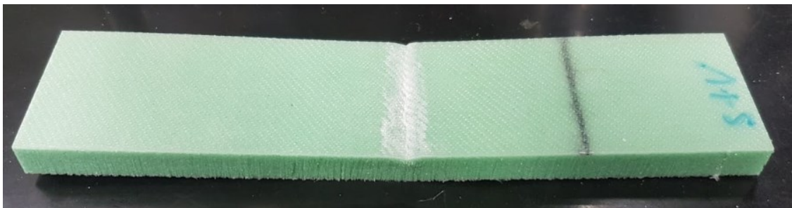
Obr. 53 Poškozené zkušební tělísko po zkoušce statickým tříbodovým ohybem
