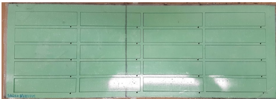
Obr. 46 Sendvičový panel po rozřezání vodním paprskem
