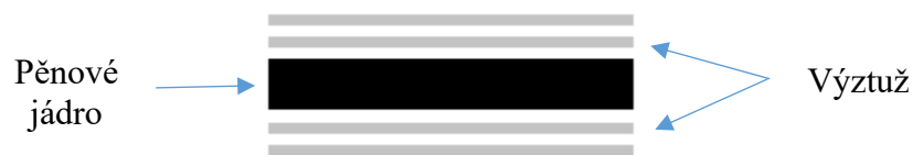
Obr. 38 Struktura vyráběného sendviče
