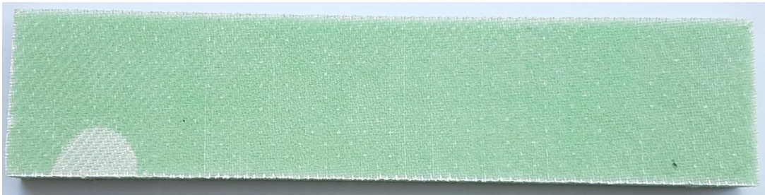
Obr. 48 Delaminace zkušebního tělíka po řezání vodním paprskem (nepohledová strana)
