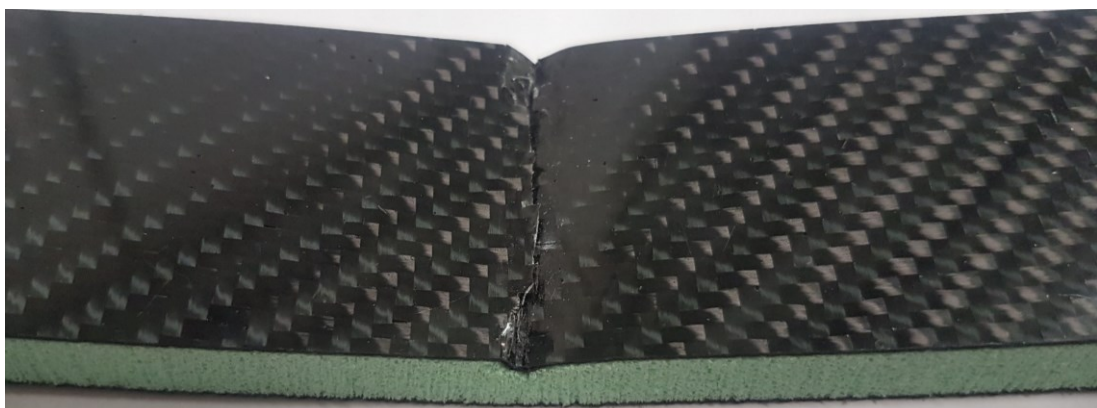
Obr. 90 Detail únavového lomu
