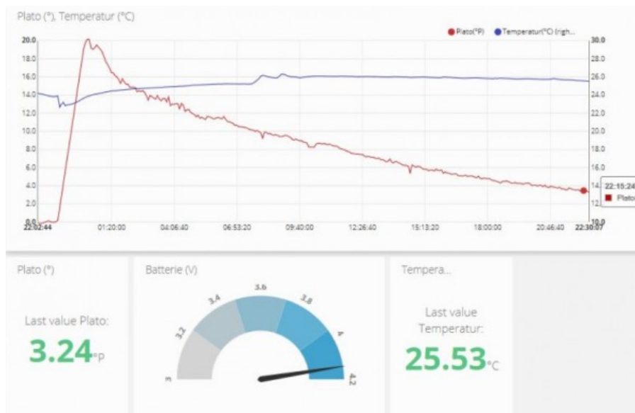
Obr. č. 20 – Monitoring kvasného procesu pomocou ISpindle (Zdroj: https://www.ispindel.de/docs/README_en.html )
