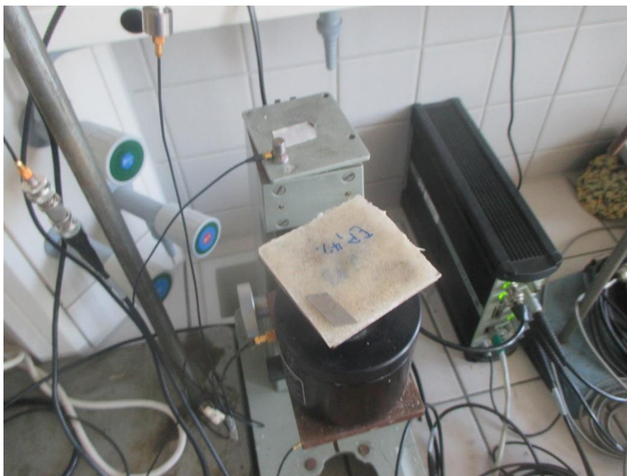
Obr. 89: Fotografie aparatury pro měření přenosového útlumu vzorku EP 4 % před měřením
