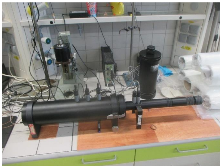
Obr. 81: Kundtova impedanční trubice
