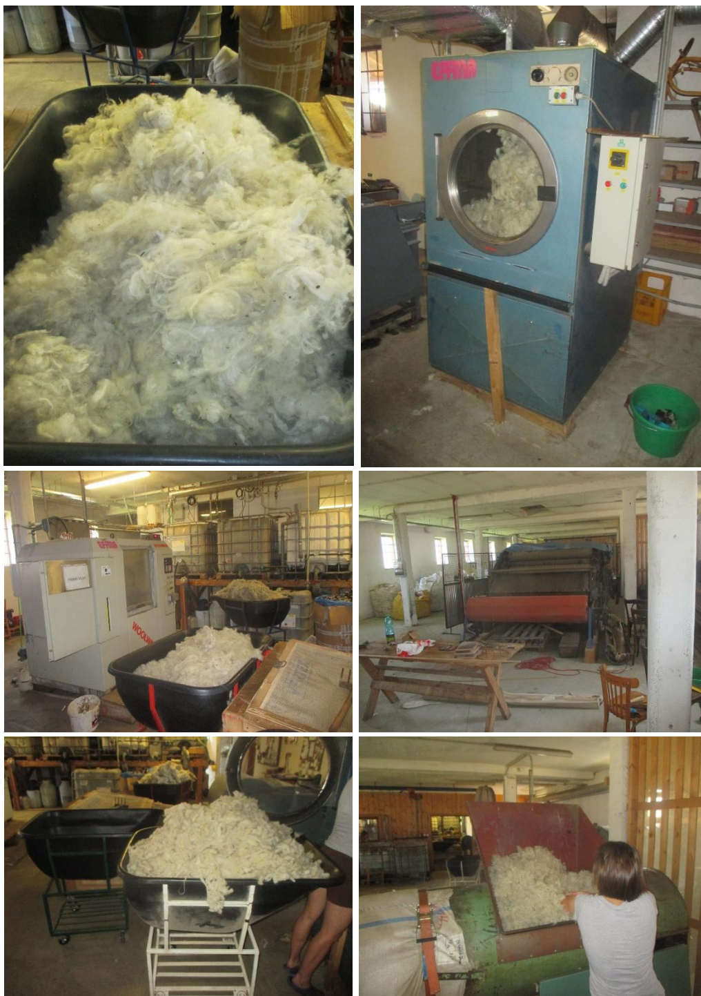
Obr. 5: Technologie praní ovčí vlny (foto autora)
