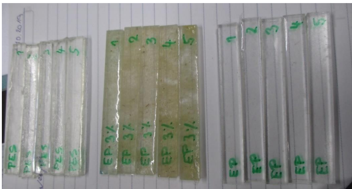
Obr. 21: Zkušební tělesa UP 0 %, EP 3 % a EP 0 % před měřením.
