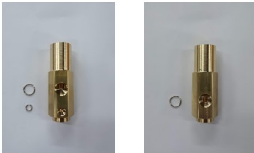
Obrázok 14 Teleso pred vloženíím letovacieho krúžku (vlastné spracovanie)
