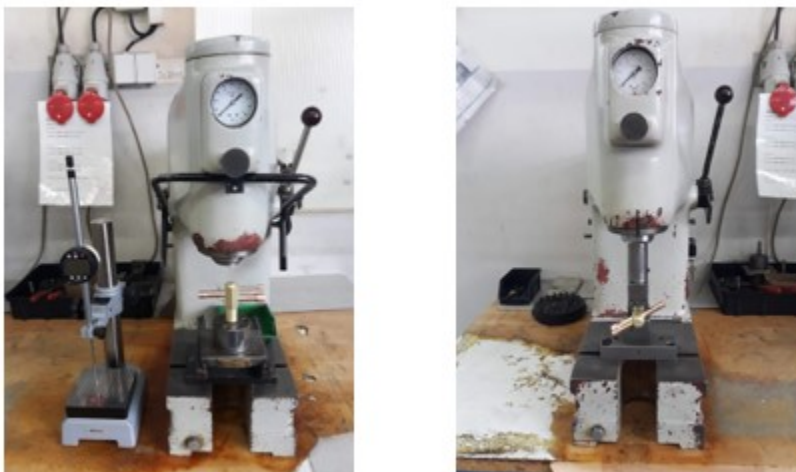
Obrázok 17 Zalisovanie trysky a razenie označenia (vlastné spracovanie)
