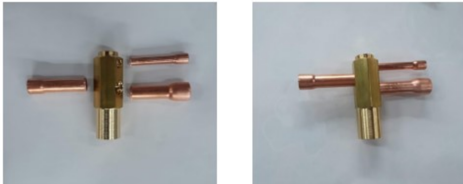
Obrázok 15 Teleso pred a po zalisovaní trubiek (vlastné spracovanie)
