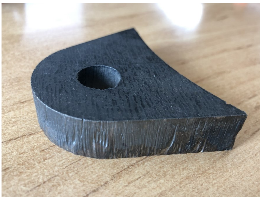
Obr. 10. Ukázka řezu oxidační metodou [Vlastní zdroj]
