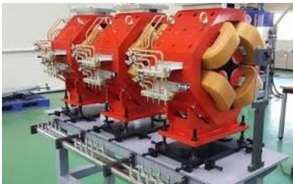
Obrázek 1: Elektromagnety urychlovače částic [5]
