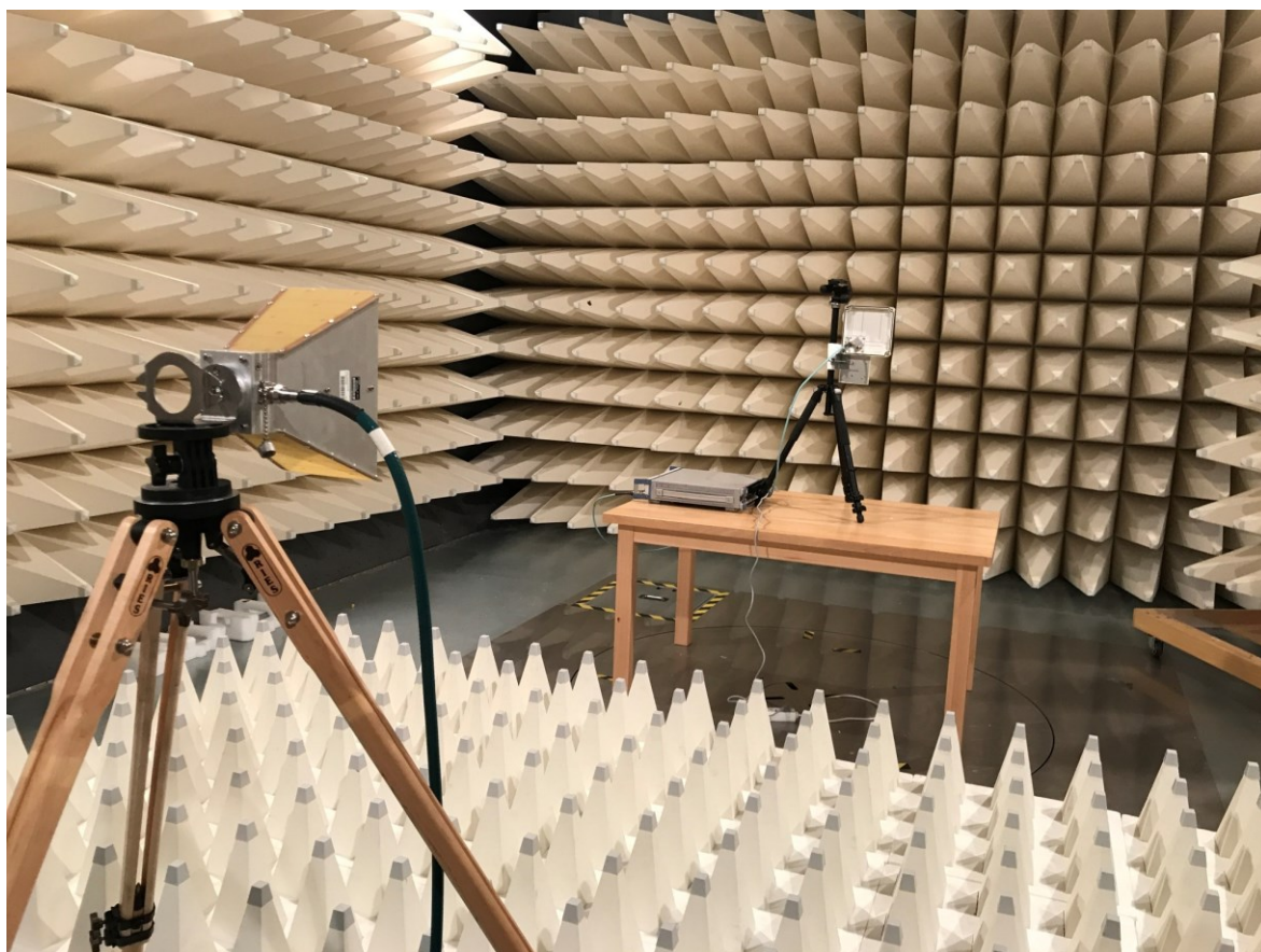
Obr. 32 Pozice antén při měření Horizontální polarizace v azimutu pro výrobce Jirous
