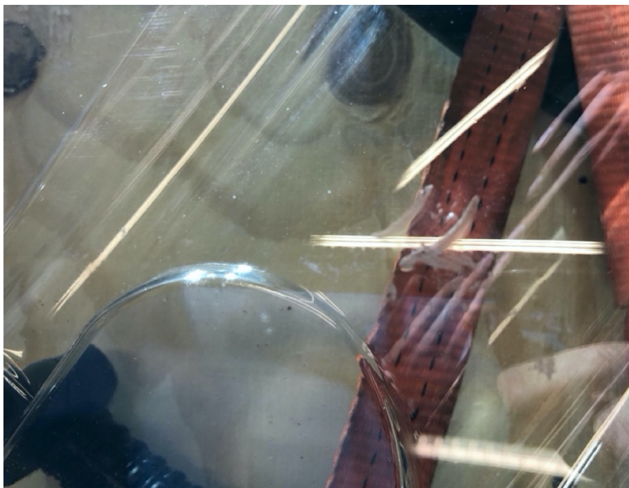
Obr. 69. Škrabance spôsobené pádmi tehly.
