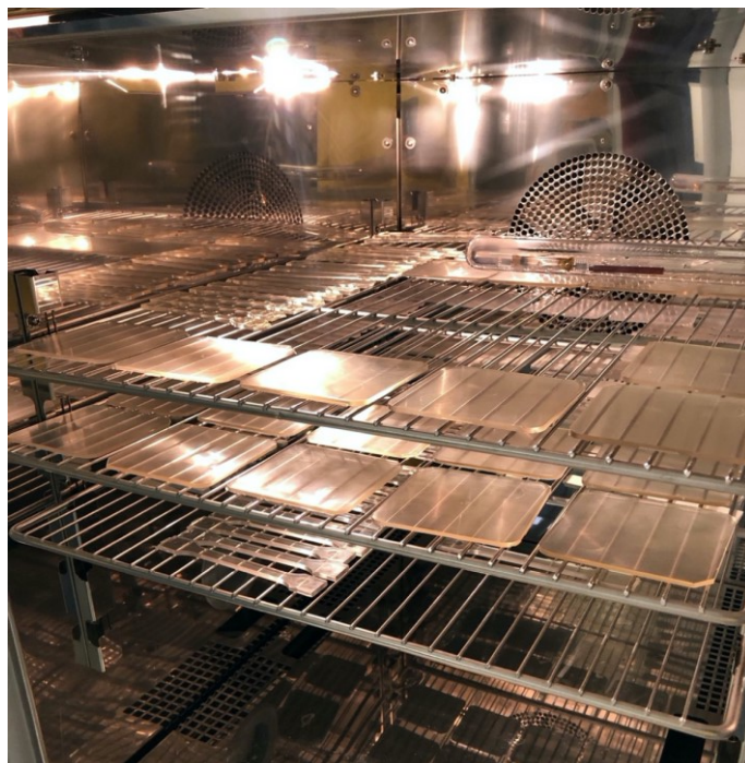
Obr. 52. Skúšobné telesá uložené v klimatickej komore.
