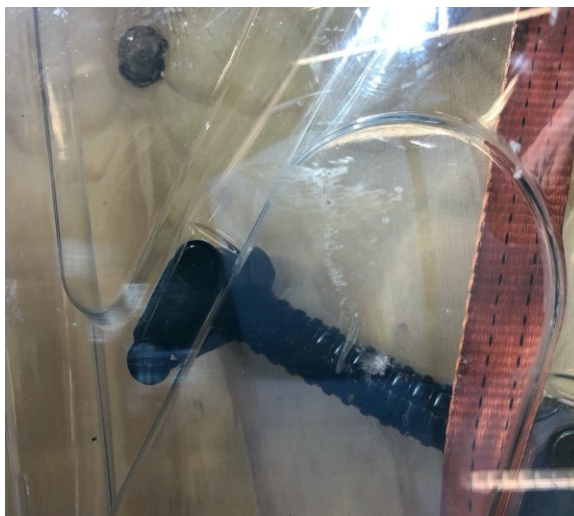
Obr. 71. Zasiahnuté miesto štítu po 2 úderoch s kladivom.
