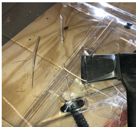
Obr. 74. Väčšia sekera po štvrtom údere zaseknutá v štíte.
