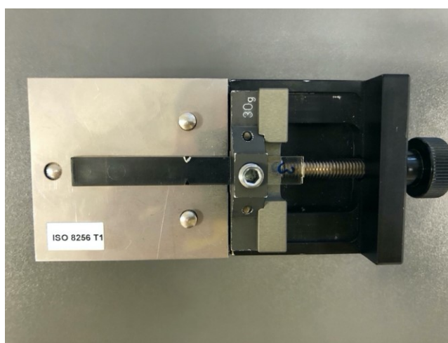
Obr. 56. Skúšobné teleso upevnené v priečniku podľa ČSN EN ISO 8256.
