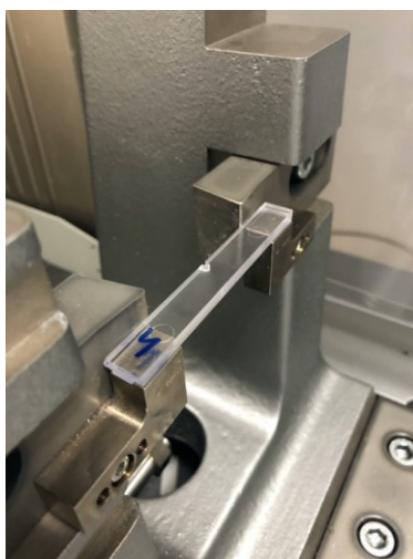
Obr. 55. Skúšobné teleso s V vrubom – meranie vrubovej húževnatosti Charpyho metódou.
