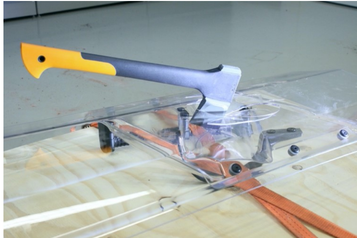
Obr. 73. Prasknutie strednej časti štítu po druhom údere menšou jednoručnou sekerou.
