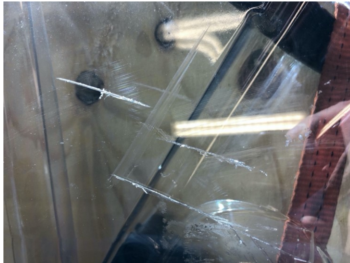
Obr. 72. Zasiahnuté miesto štítu po 2 úderoch s mačetou, ktorá zanechala rezné stopy.
