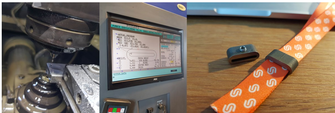
Fot. 9 Vlastní fotografie elektroerozivního stroje a výrobku
