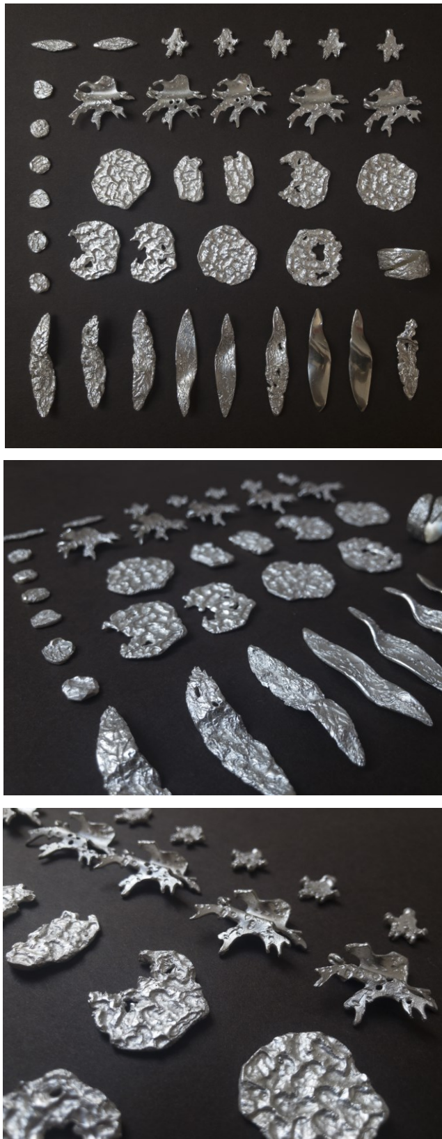
Obr. 109 Základné časti šperkov odlievané technológiou strateného vosku
