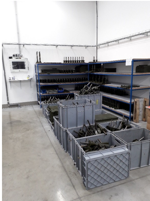
Obrázek 19 Současný způsob skladování vtokových soustav (vlastní zpracování)
