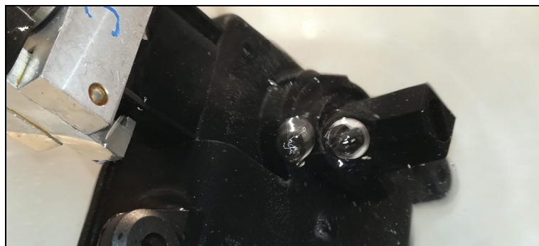
Obr. 46: Bublinkový test – detail úniku u hřídele
