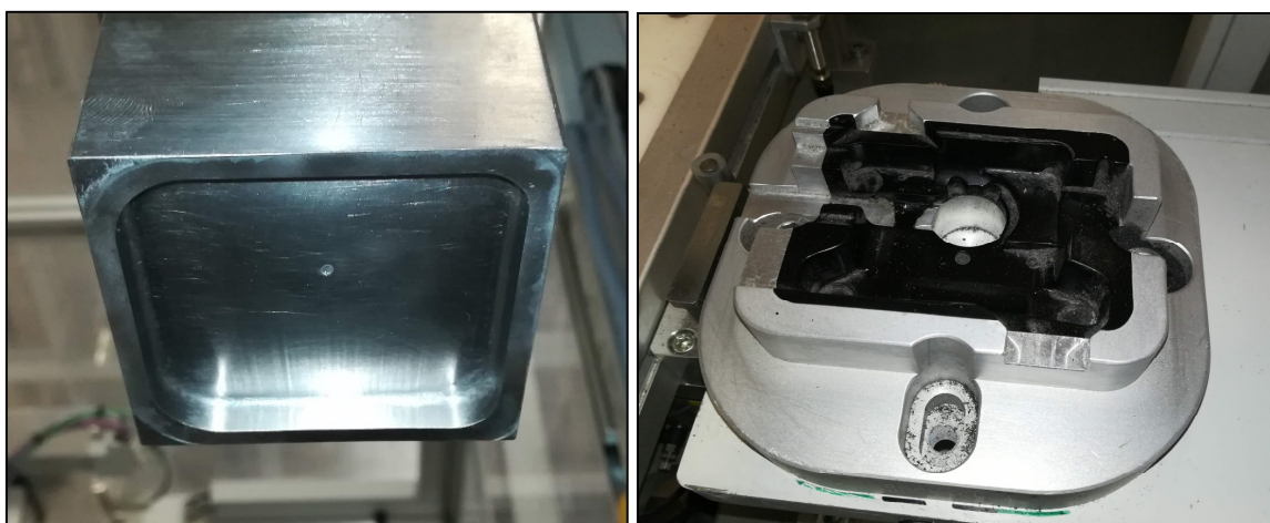
Obr. 48: Sonotroda (vlevo); hnízdo, pevný přípravek (vpravo)
