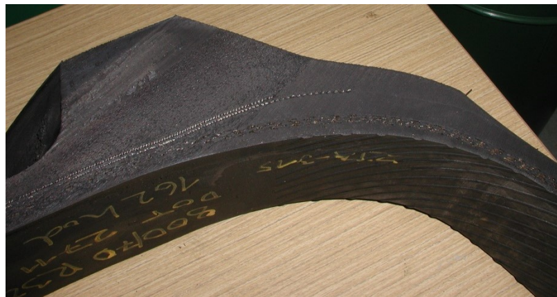
Obrázek 62 Analýza řezu pneumatiky / Nová verze / Vzorek č.6
