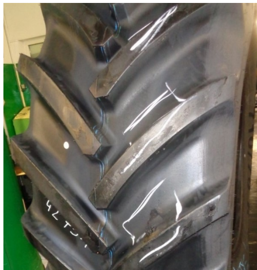
Obrázek 55 Vada pneumatiky po zkoušce trvanlivosti – Vzorek č. 6
