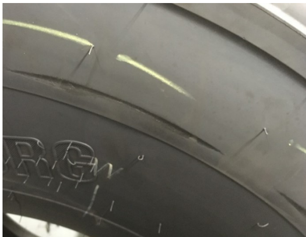
Obrázek 31 Nedolisek v bočnici (www.mitas-tyres.com)
