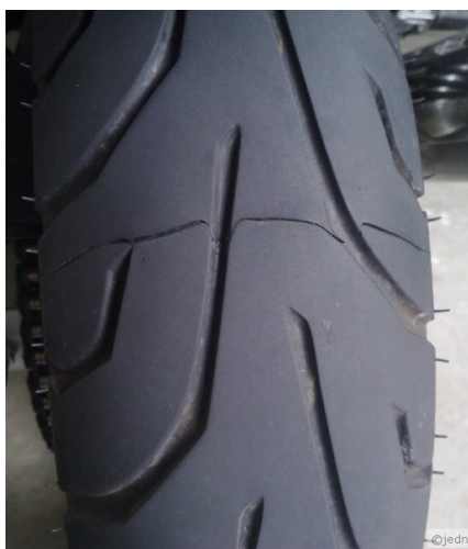
Obrázek 34 Povolný spoj běhounu (www.mitas-tyres.com)
