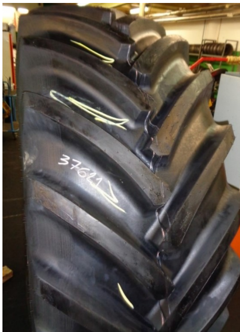
Obrázek 50 Vada pneumatiky po zkoušce trvanlivosti – Vzorek č. 2
