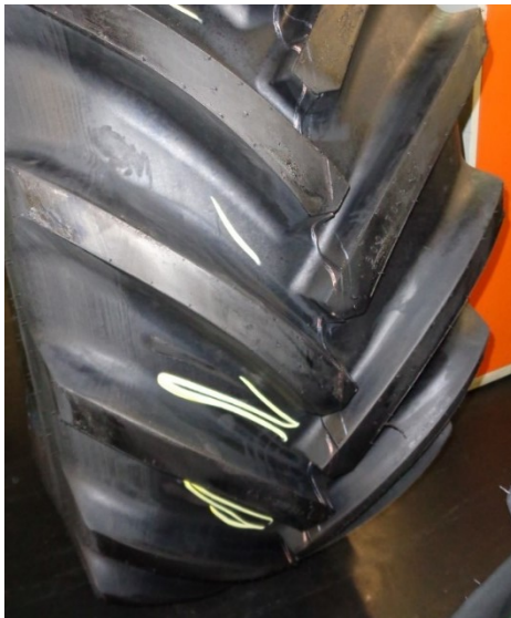
Obrázek 52 Vada pneumatiky po zkoušce trvanlivosti – Vzorek č. 4
