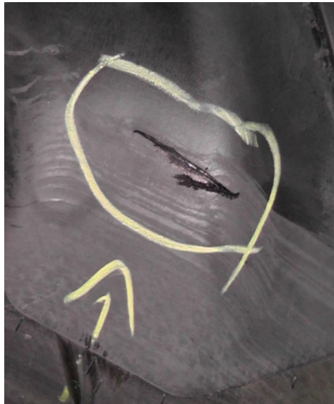
Obrázek 49 Vady pneumatik po zkoušce trvanlivosti – Vzorek č. 1
