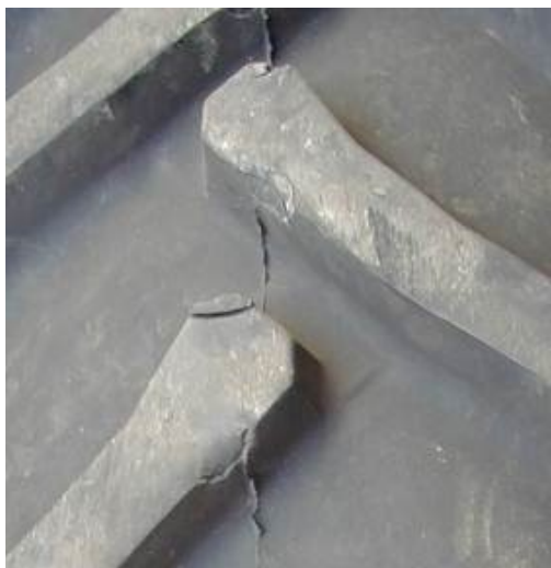
Obrázek 47 Zatrhané zuby běhounu
