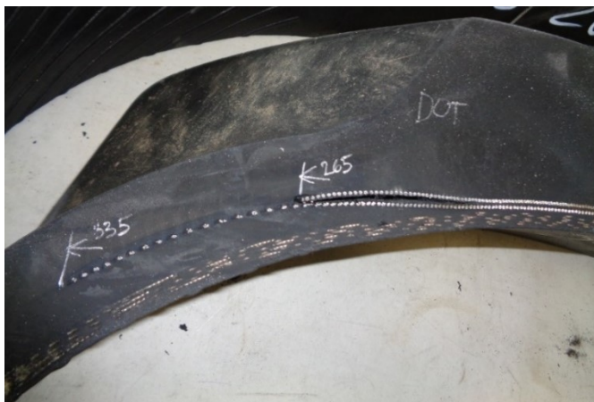
Obrázek 57 Analýza řezu pneumatiky – Vzorek č.1
