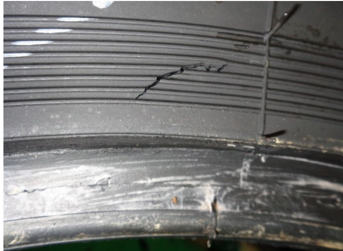
Obrázek 54 Vada pneumatiky po zkoušce trvanlivosti – Vzorek č.6
