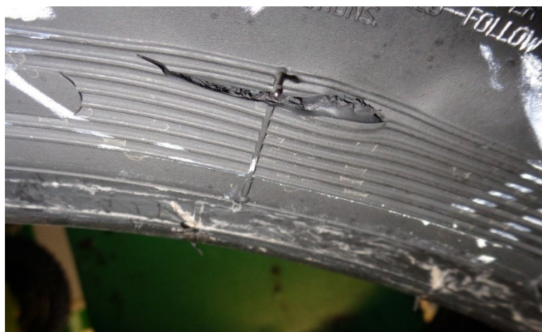
Obrázek 53 Vada pneumatiky po zkoušce trvanlivosti – Vzorek č. 5
