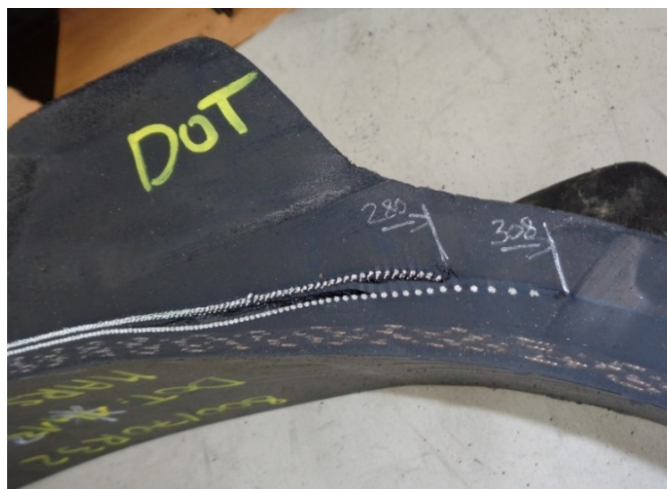
Obrázek 60 Analýza řezu pneumatiky – Vzorek č.4
