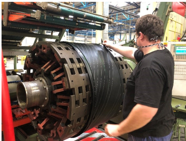
Obrázek 46 Pokládání ocelových nárazníků na nárazníkový buben
