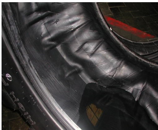
Obrázek 36 Převulkanizovaný plášť ( www.mitas-tyres.com )
