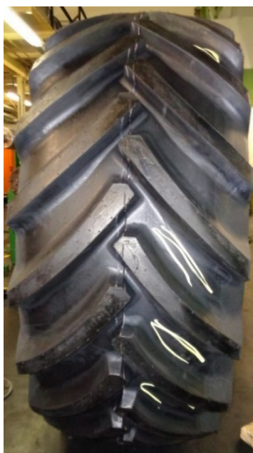
Obrázek 51 Vada pneumatiky po zkoušce trvanlivosti – Vzorek č. 3
