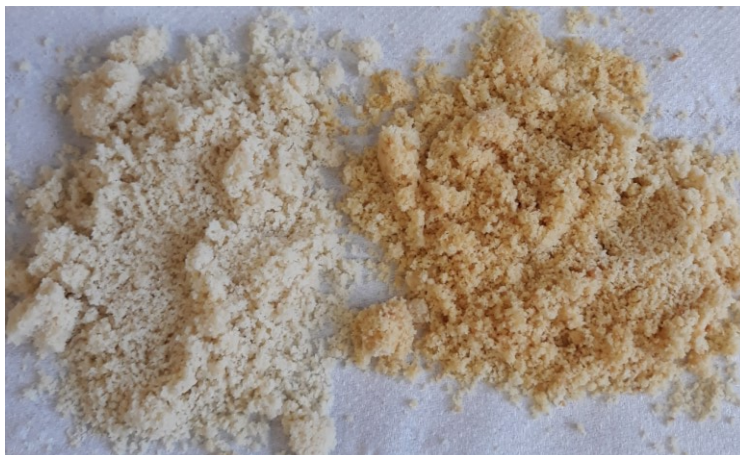
Obrázek 13: Vzorek mandlí před (vlevo) a po (vpravo) vyhodnocení oxidační stability
