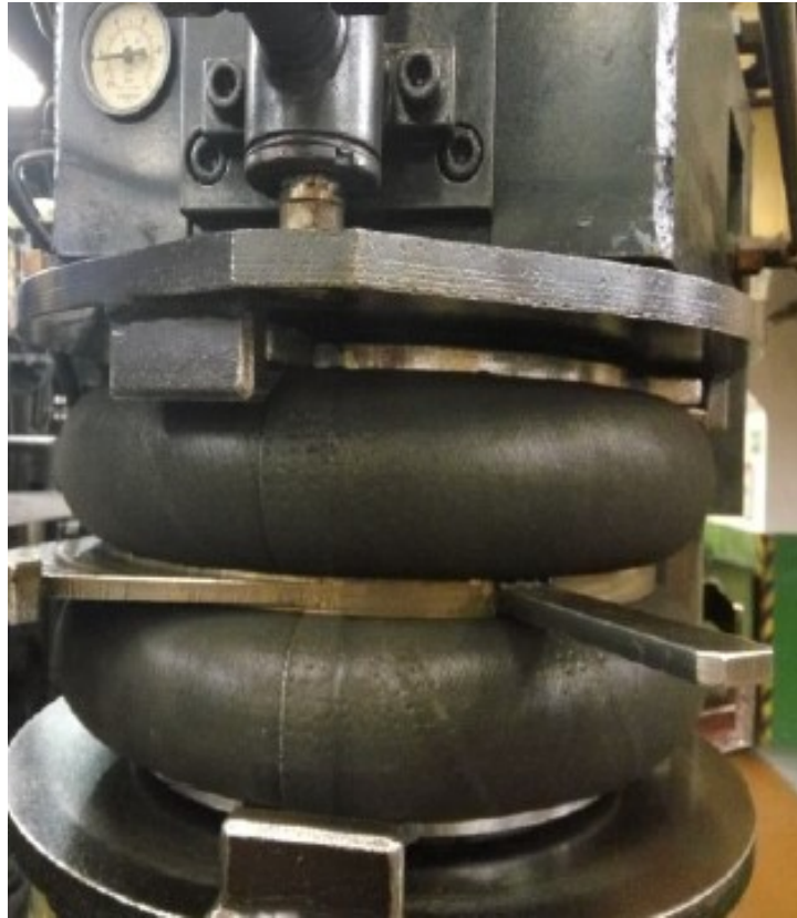
Obrázek 21 Bombírování konfekce vzduchové pružiny [17]
