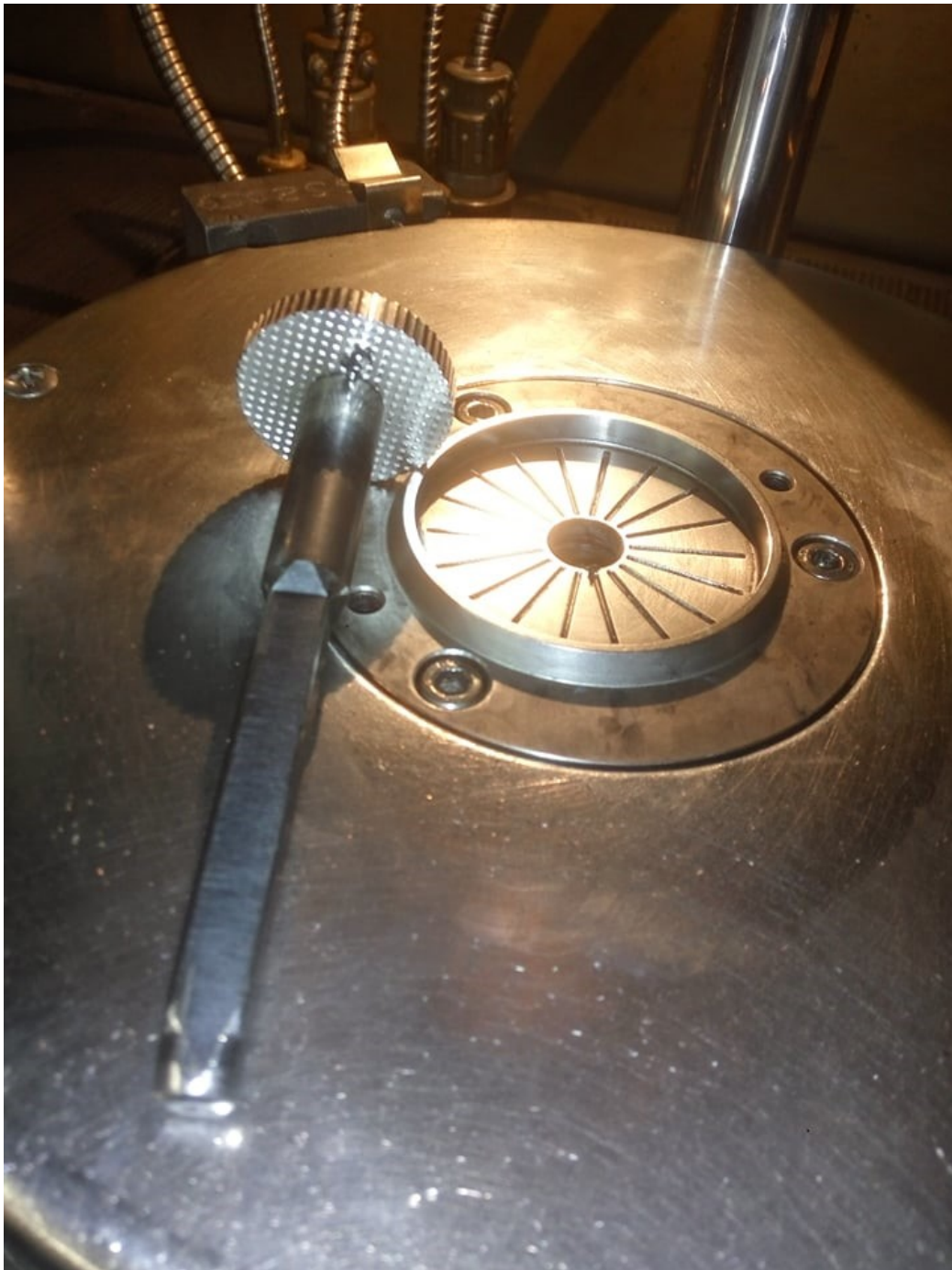
Obrázek 18 Spodní polovina formy a smykový disk pro měření viskozity Mooney
