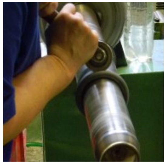
Obrázek 26 Postup otáčení pogumovaného kordu okolo zpevňujícího kroužku patky. Položení opěrných pásků, osazení zpevňujících patních kroužků, přehrnutí pogumovaného textilu okolo kroužků, vyválněčkování uzavřených vzduchů z patky vzduchové pružiny.
