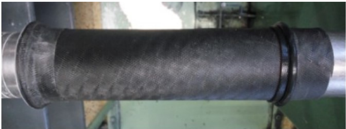
Obrázek 20 Polotovar konfekce, vlevo pogumovaný kord otočený kolem patkového kroužku, vpravo před otočením [17]
