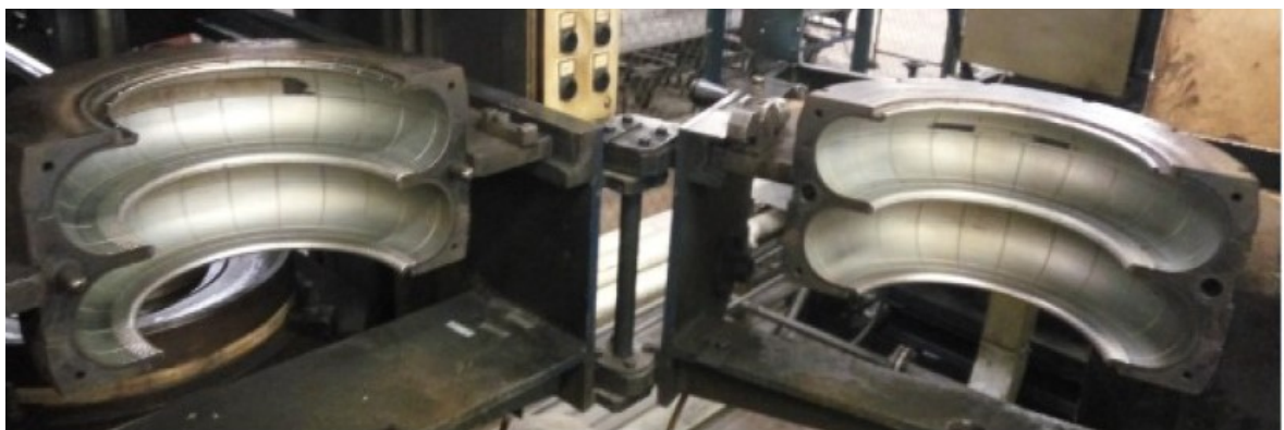
Obrázek 22 Bombírování konfekce vzduchové pružiny [17]
