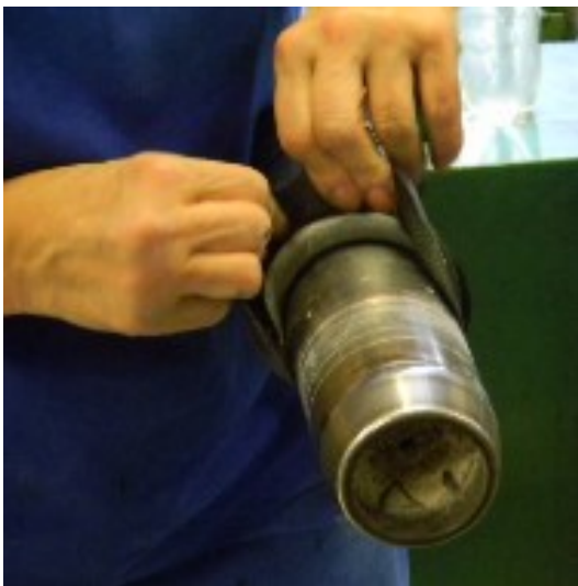
Obrázek 26 Postup otáčení pogumovaného kordu okolo zpevňujícího kroužku patky. Položení opěrných pásků, osazení zpevňujících patních kroužků, přehrnutí pogumovaného textilu okolo kroužků, vyválněčkování uzavřených vzduchů z patky vzduchové pružiny.
