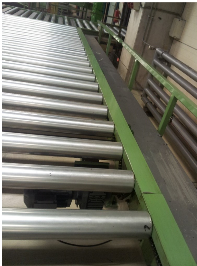
Obr. 32: Poháněné válečky pomocí řetězu
