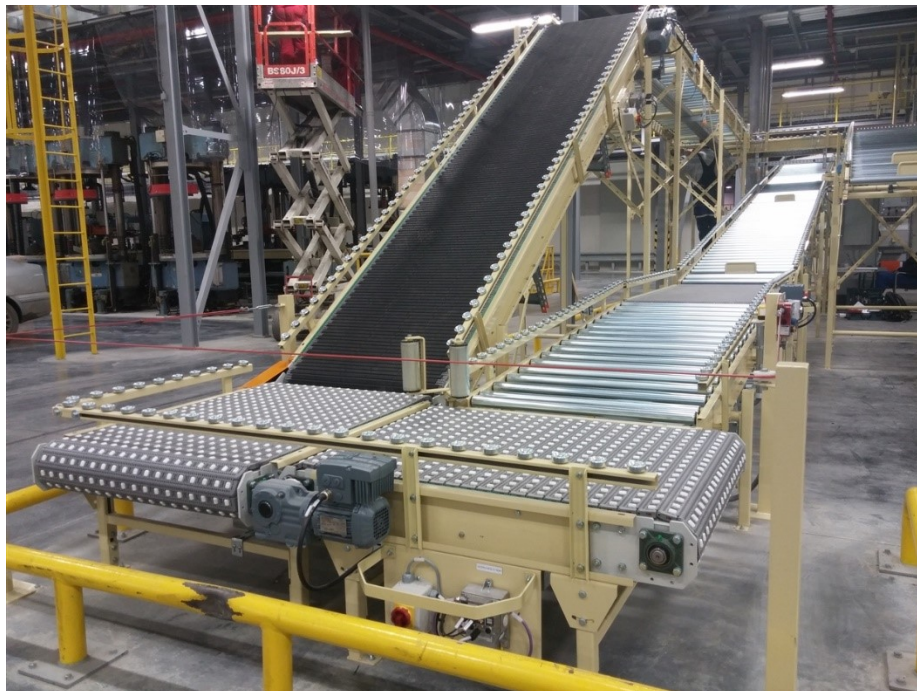
Obr. 1: Ukázka mezioperační dopravní tratě na osobní pneumatiky [7]
