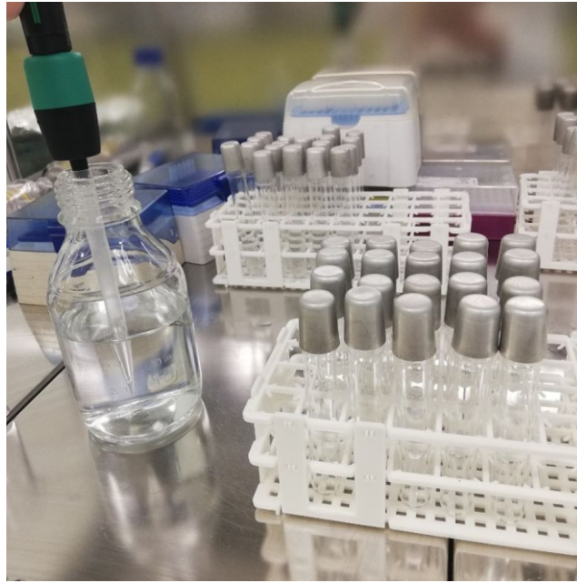
Obr. 16 Pipetování fyziologického roztoku
