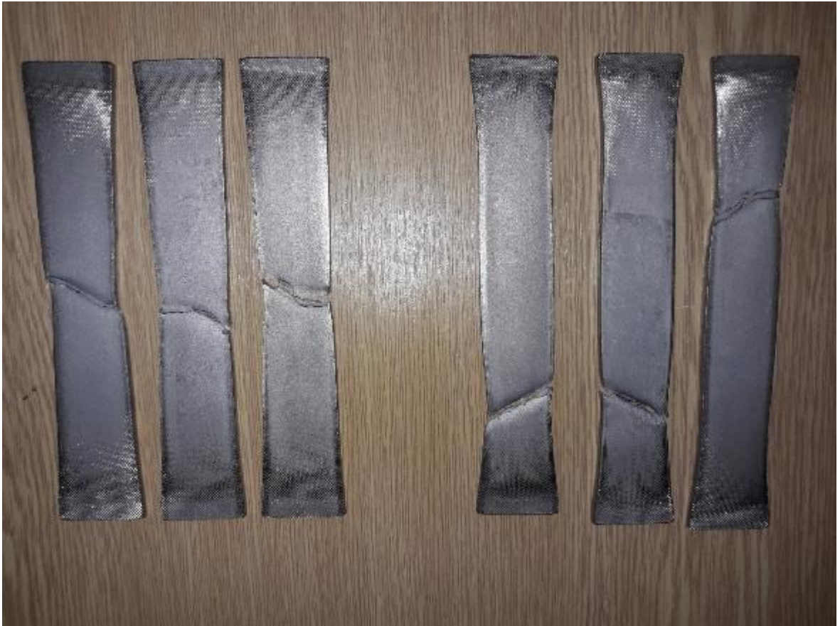
Obrázek 16 - Přetržená tělesa obdélníkového průřezu po tahové zkoušce – vlevo zkoušená tělesa o teplotě 20°C, vpravo o teplotě -30°C
