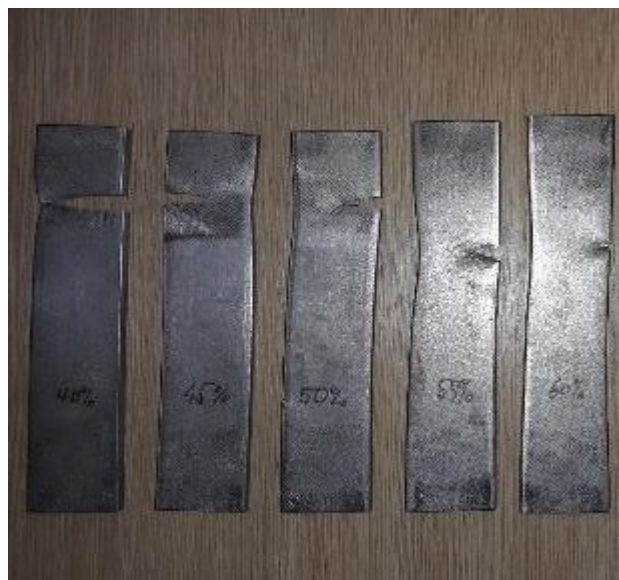
Obrázek 28 - Porušená tělesa po provedení cyklické zkoušky
