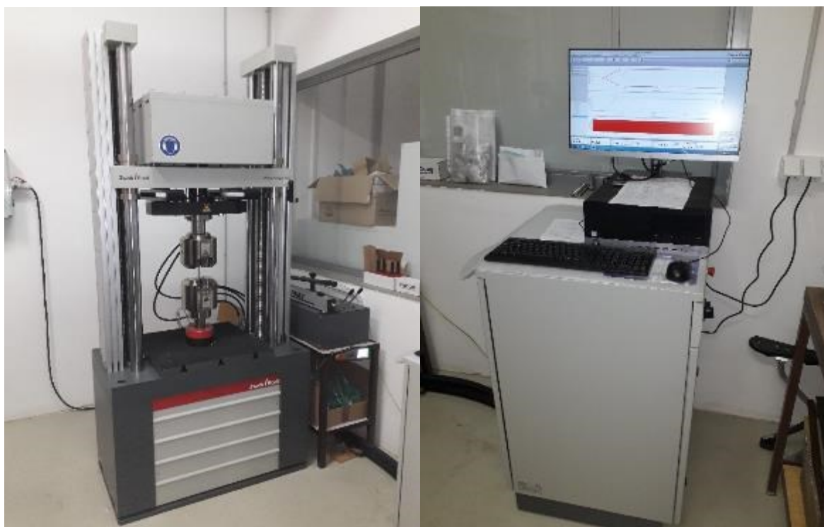
Obrázek 11 - Stroj Zwick/Roell Vibrophore 100
