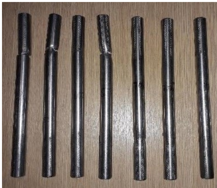
Obrázek 31 - Porušená tělesa po provedení cyklické zkoušky
