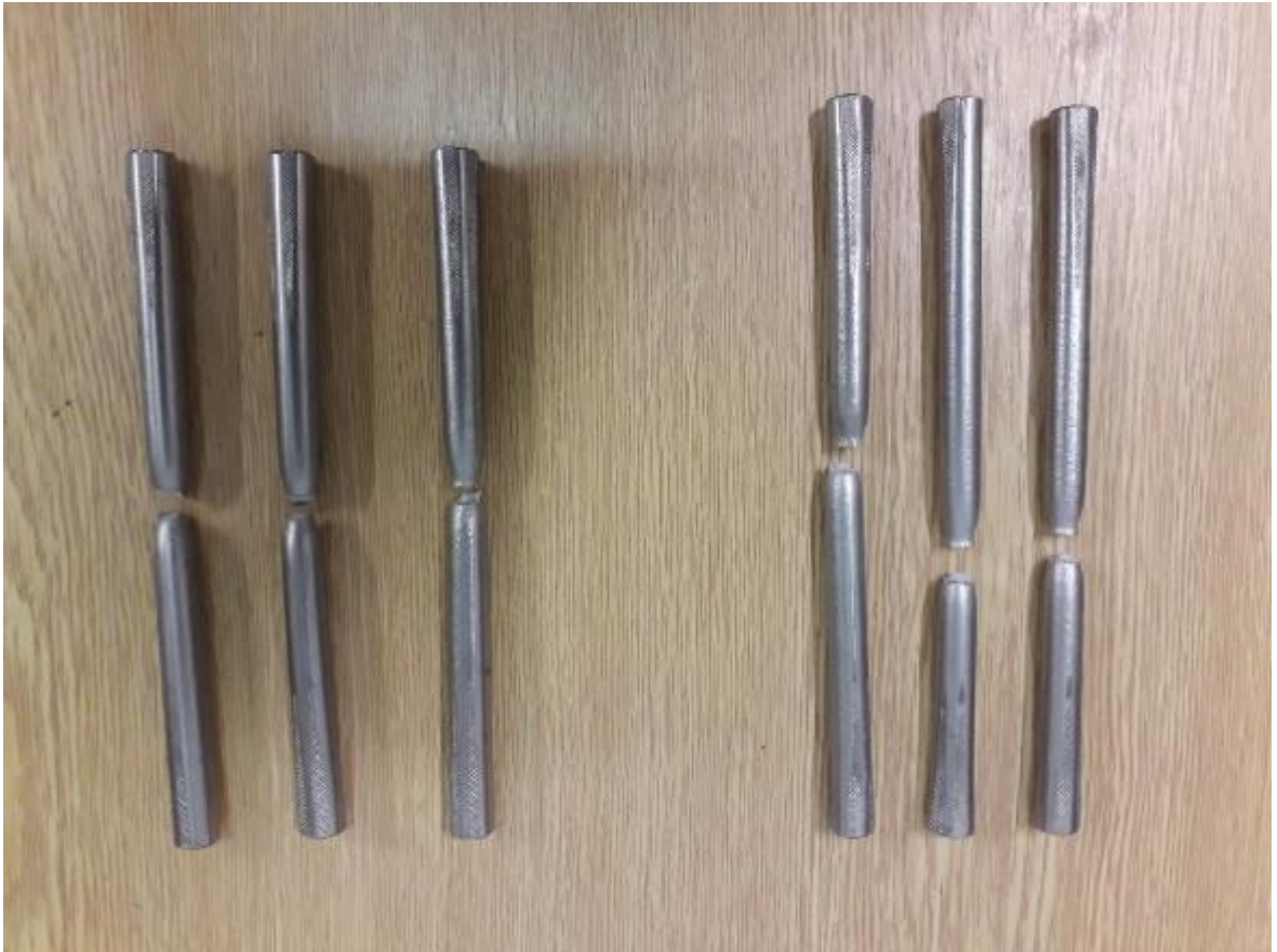
Obrázek 21 - Přetržená tělesa kruhového průřezu po tahové zkoušce – vlevo zkoušená tělesa o teplotě 20°C, vpravo o teplotě -30°C
